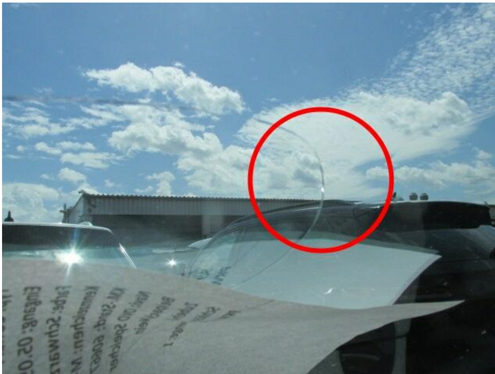
Bild 26 : WSS Steinschlag mit Rißbildung
