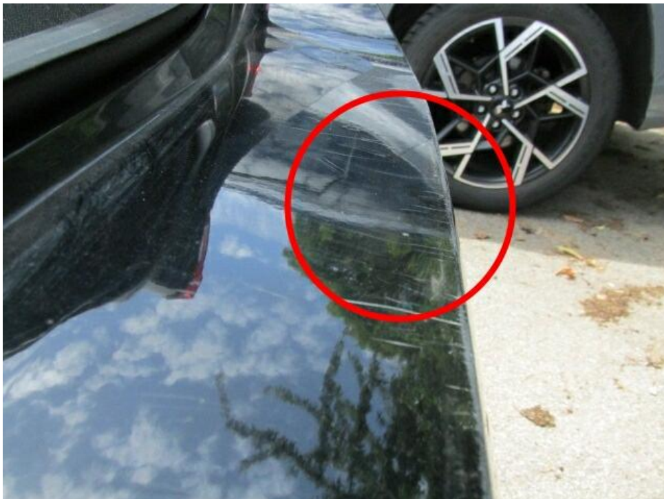
Bild 20 : Stoßfänger hinten deformiert
