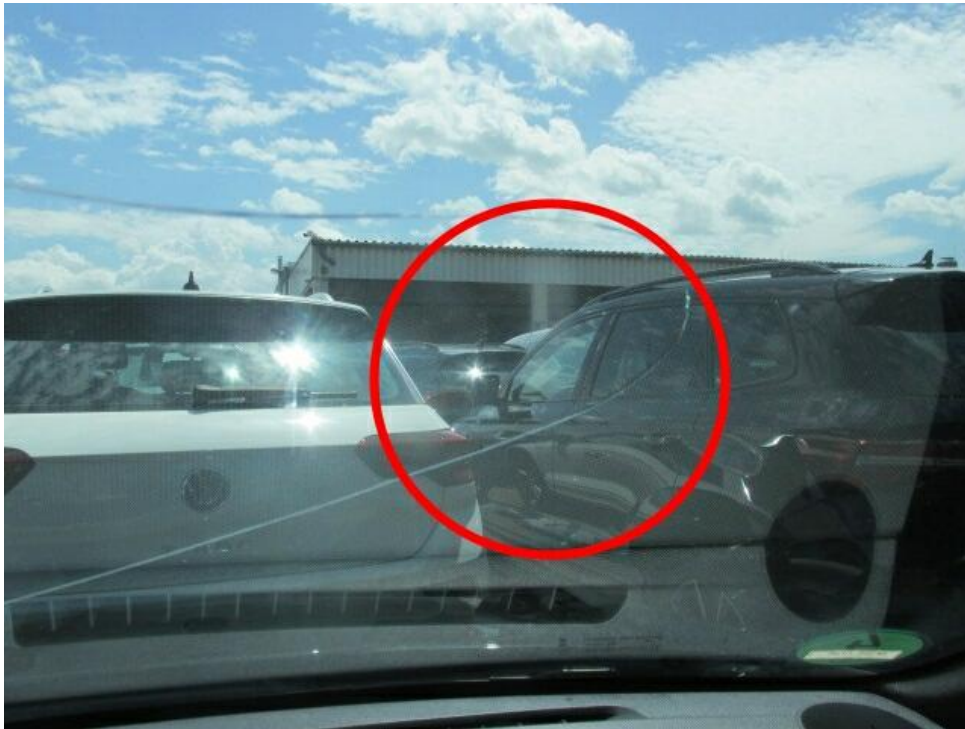
Bild 25 : WSS Steinschlag mit Rißbildung
