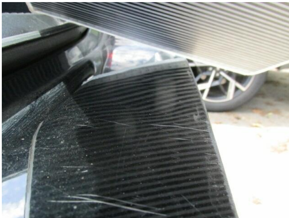
Bild 21 : Stoßfänger hinten deformiert
