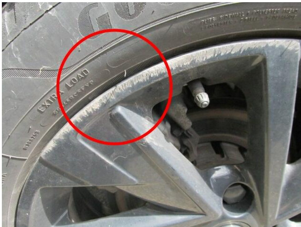
Bild 16 : Felge hinten rechts verschrammt ( lackiert).
