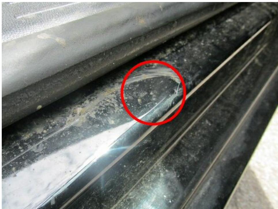
Bild 14 : Einstieg vorne rechts Delle
