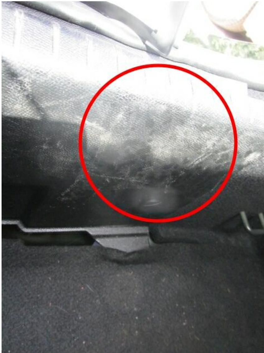
Bild 22 : Abdeckung Heckblech innen verschrammt
