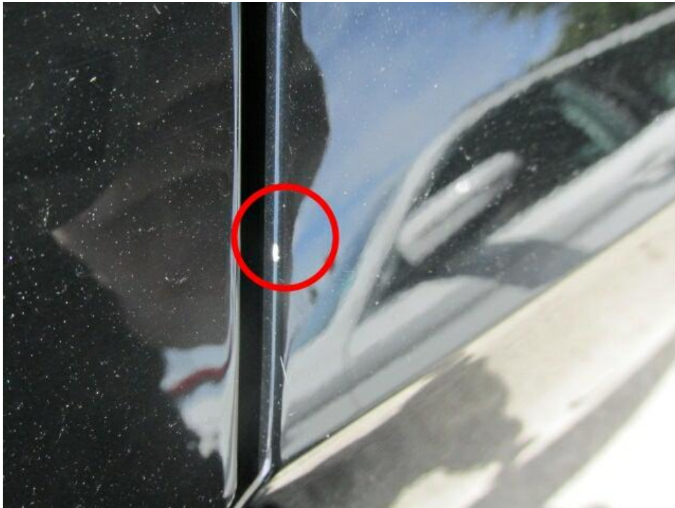
Bild 23 : Seitenwand hinten links Kante angeschlagen
