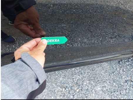
Puerta / Delantero Derecho / Abolladura
