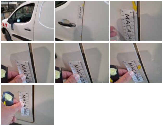
Door trim FL, Scratch(es), Replace
