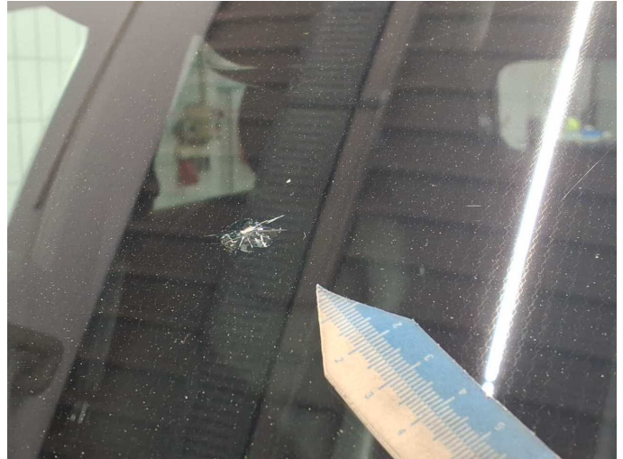
Damage 7: Vehicle glazing: Windscreen (mit Rissbildung) - Stone chips - Replace
