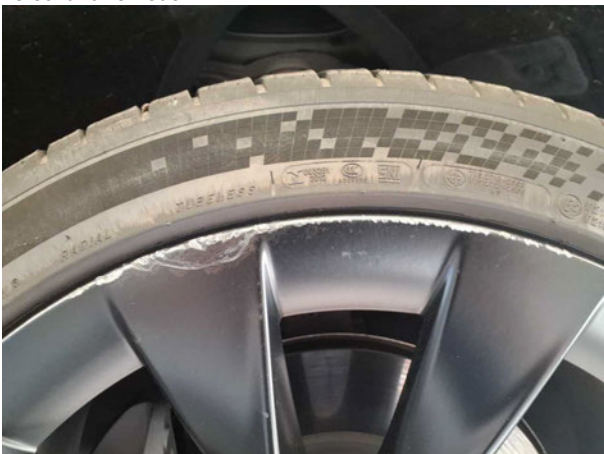
Beschädigung #8: Rad/Reifen: Leichtmetallfelge vorn rechts - verkratzt / verschürft - erneuern
