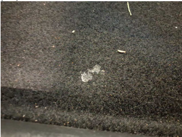
Beschädigung #3: Verkleidungen/Abdeckungen: Teppichboden vorn links - Brandloch - erneuern
