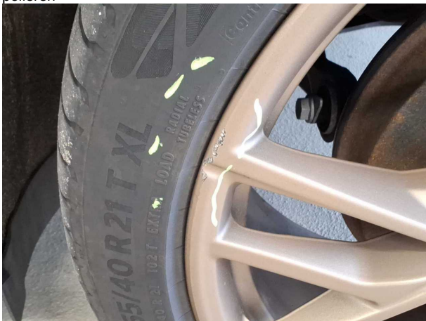
Beschädigung #4: Rad/Reifen: Leichtmetallfelge hinten links - verkratzt / verschürft - Wertminderung
