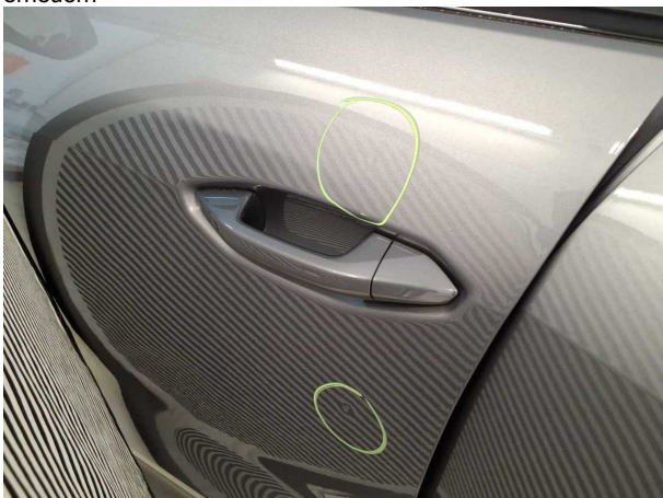
Beschädigung #9: Tür vorn links: Tür - Delle(n) - sanft instandsetzen
