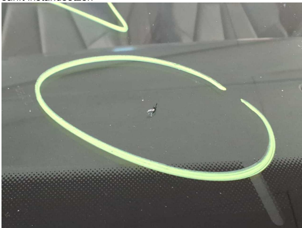
Beschädigung #13: Verglasung: Frontscheibe - Steinschlag - erneuern
