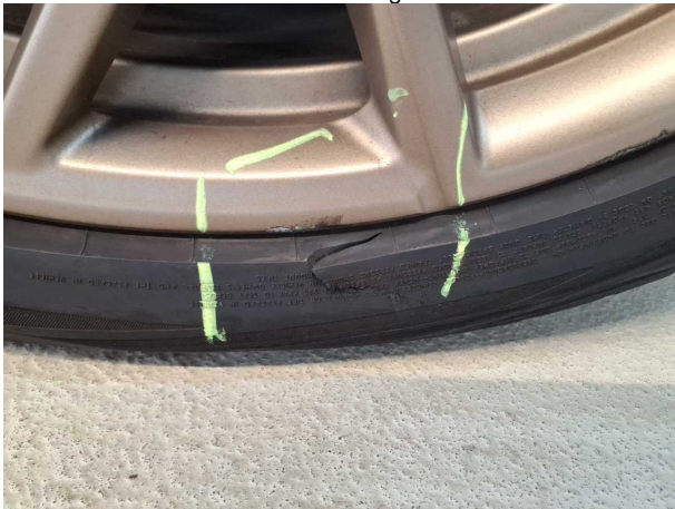
Beschädigung #8: Rad/Reifen: Reifen vorn rechts - beschädigt - erneuern
