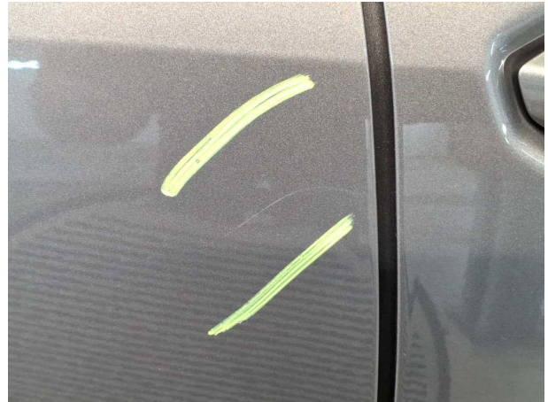
Beschädigung #3: Tür hinten rechts: Tür - Kratzer - auslegen / polieren
