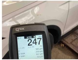
Lackstärke Kotflügel vorne links
