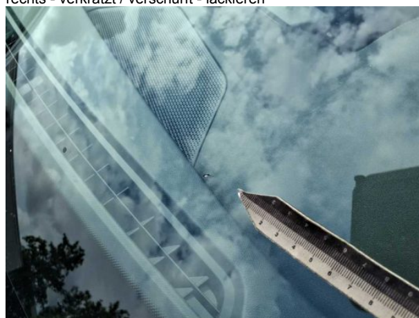
Beschädigung 11: Verglasung: Frontscheibe - gebrochen / gerissen - erneuern
