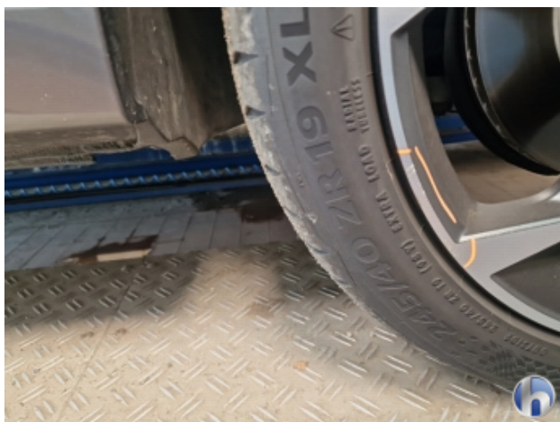
7. Felge Vorne - Rechts Kratzer - Smart Repair
