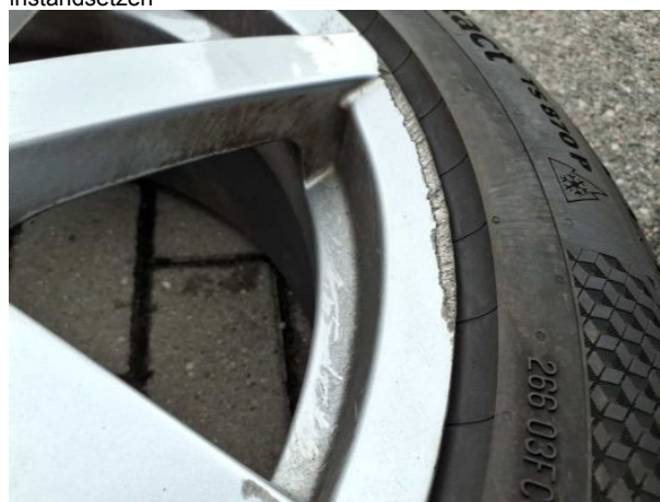
Beschädigung 5: 2.Radsatz: 1 Leichtmetallfelge - verkratzt / verschürft - Wertminderung
