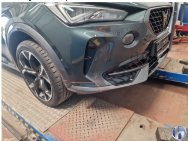
6. Stoßfänger Vorne Kratzer - Smart Repair
