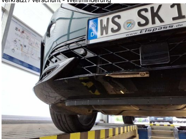
Beschädigung 8: Stoßfänger vorn: Spoiler - verformt - erneuern
