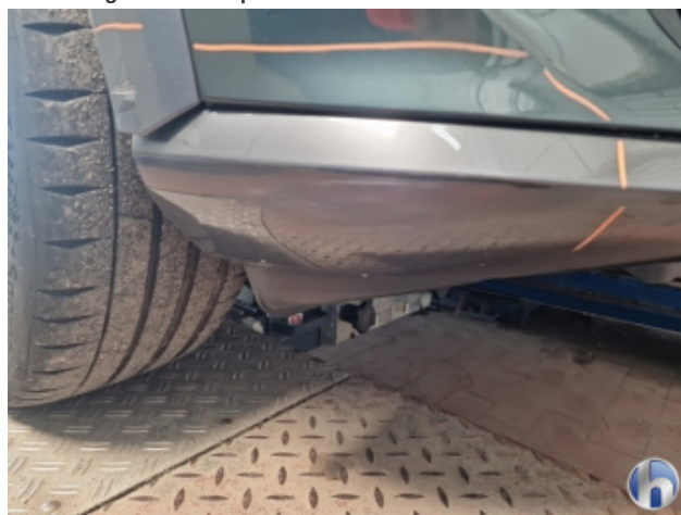
6. Stoßfänger Vorne Kratzer - Smart Repair
