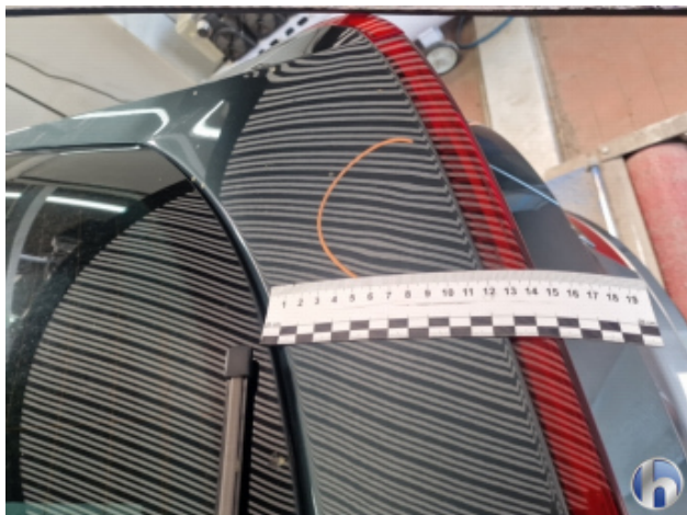
2. Heckklappe Delle - Sanft Instandsetzen
