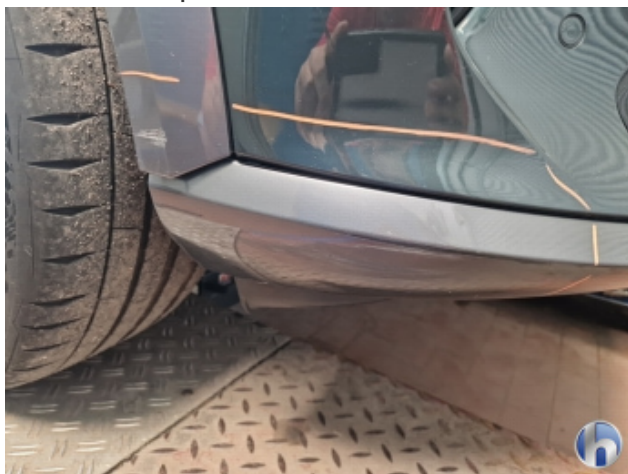
6. Stoßfänger Vorne Kratzer - Smart Repair
