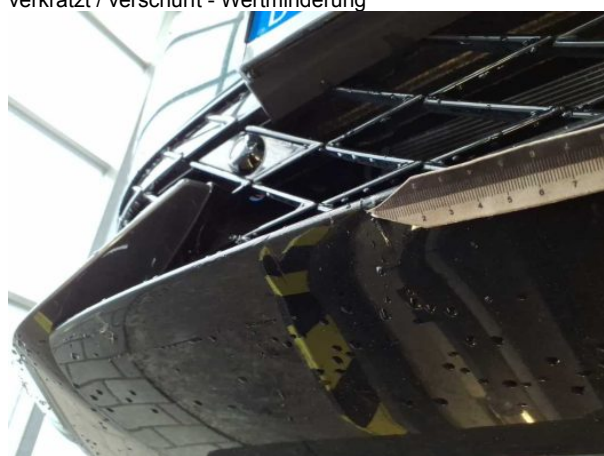
Beschädigung 8: Stoßfänger vorn: Spoiler - verformt - erneuern
