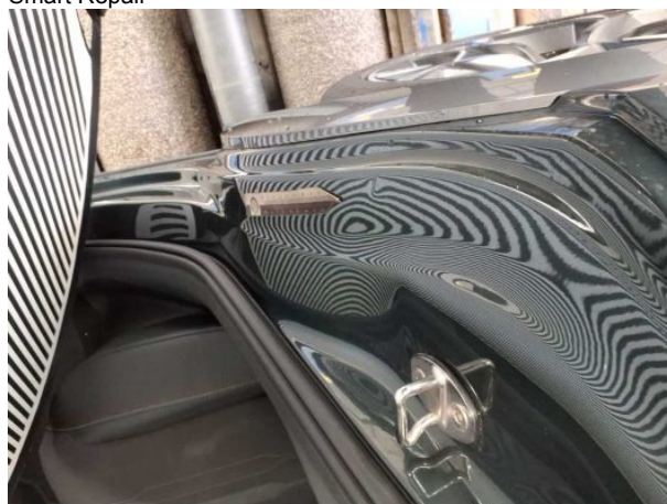
Beschädigung 3: Seitenwand rechts: Einstieg - Delle(n) - Smart Repair
