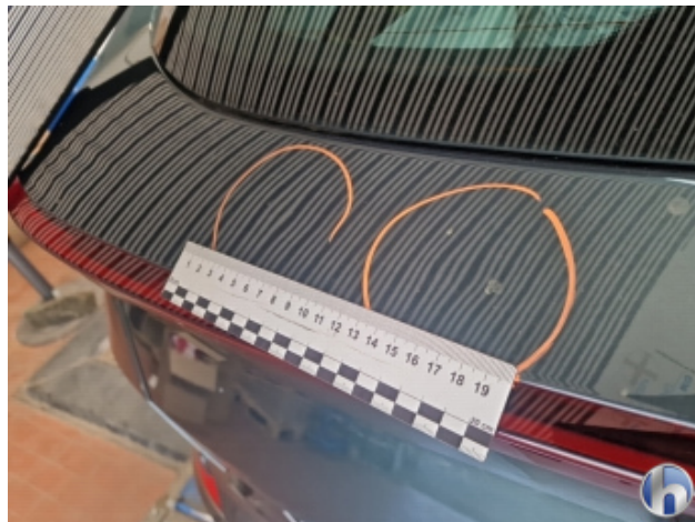
2. Heckklappe Delle - Sanft Instandsetzen
