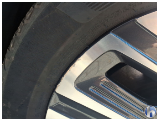
2. Felge Vorne - Rechts Beschädigt - Erneuern
