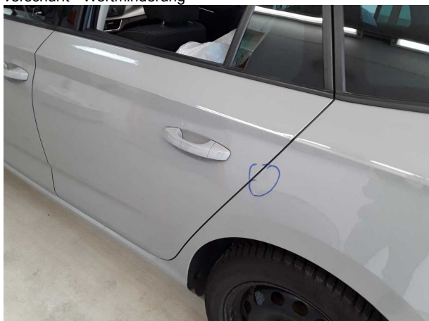
Beschädigung #5: Seitenwand links: Seitenwand - Delle(n) - sanft instandsetzen
