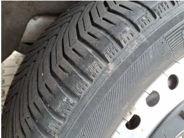
Beschädigung #4: Rad/Reifen: Reifen hinten - verschlissen - erneuern
