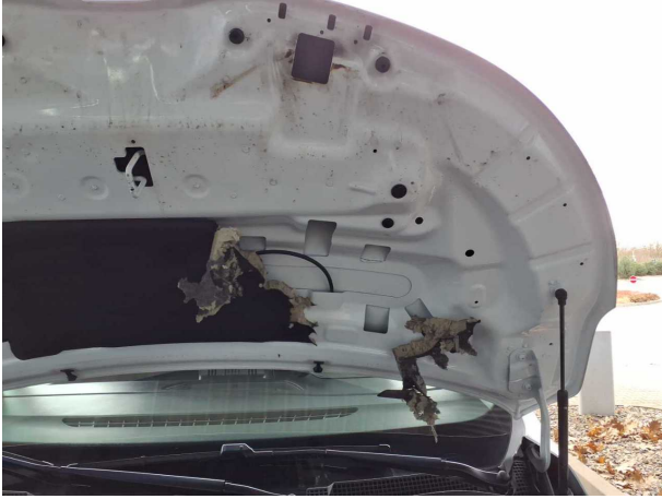
Beschädigung #1: Motorhaube: Dämmmatte - beschädigt - erneuern
