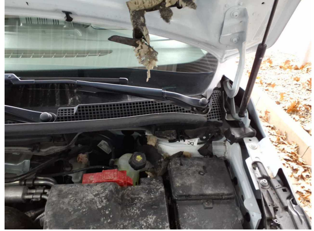
Beschädigung #1: Motorhaube: Dämmmatte - beschädigt - erneuern
