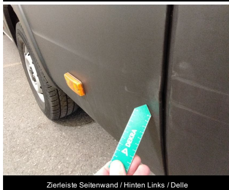
Zierleiste Seitenwand / Hinten Links / Delle
