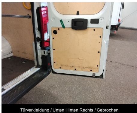
Türverkleidung / Unten Hinten Rechts / Gebrochen
