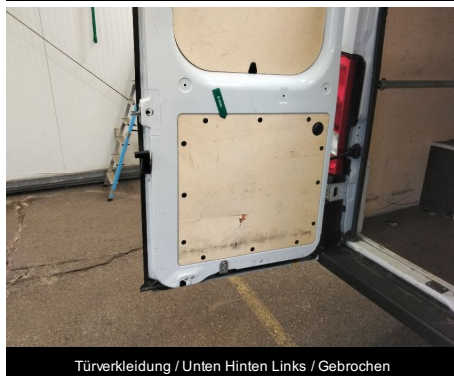
Türverkleidung / Unten Hinten Links / Gebrochen
