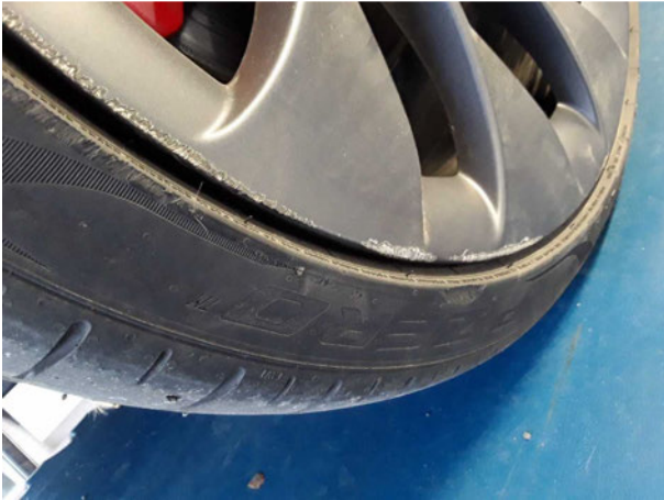
Beschädigung #2: Rad/Reifen: Leichtmetallfelge hinten rechts (Sicherheitsrelevante Beschädigung) - verkratzt / verschürft - erneuern
