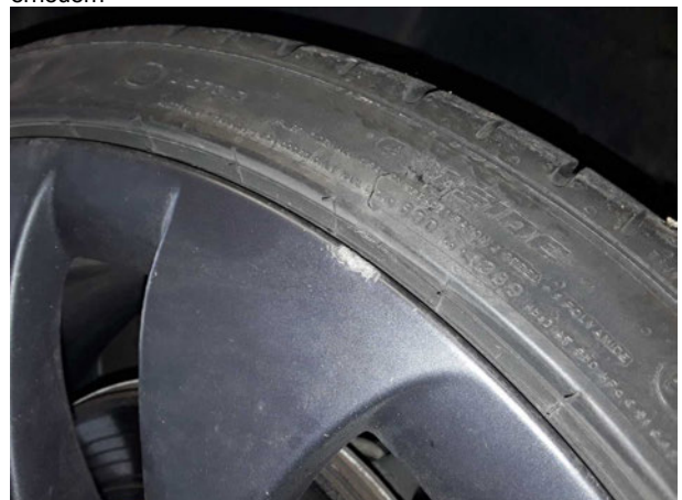
Beschädigung #2: Rad/Reifen: Leichtmetallfelge hinten rechts (Sicherheitsrelevante Beschädigung) - verkratzt / verschürft -
