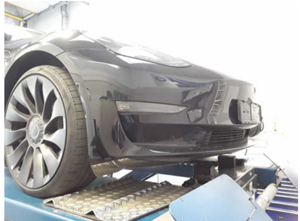
Beschädigung #4: Stossfänger vorn: Stossfänger vorn - Kratzer - lackieren
