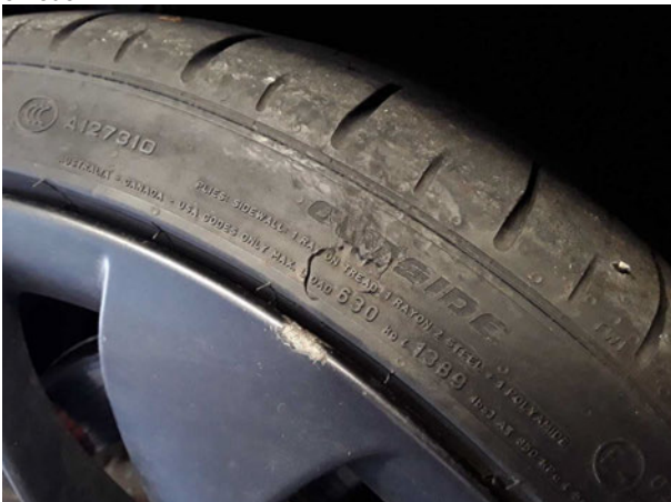
Beschädigung #1: Rad/Reifen: Reifen hinten rechts - beschädigt - erneuern
