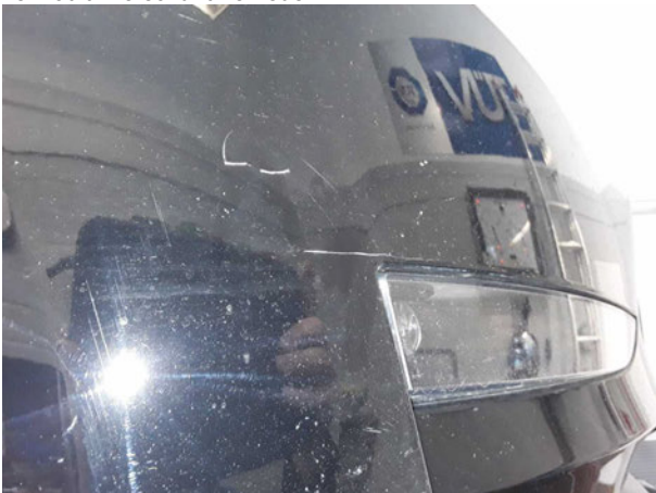
Beschädigung #4: Stossfänger vorn: Stossfänger vorn - Kratzer - lackieren
