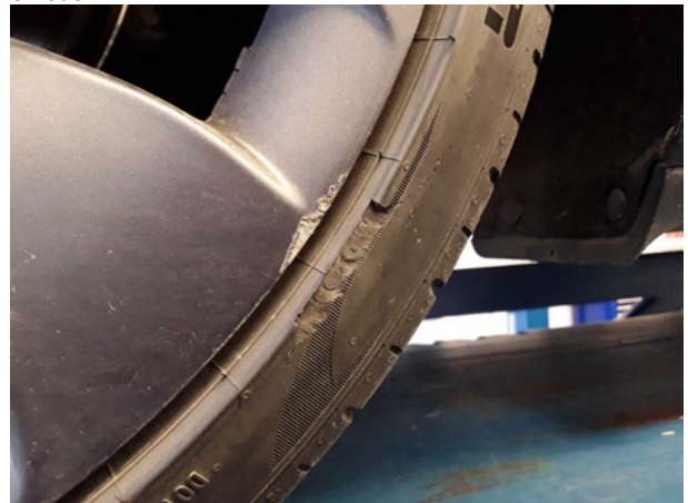
Beschädigung #1: Rad/Reifen: Reifen hinten rechts - beschädigt - erneuern
