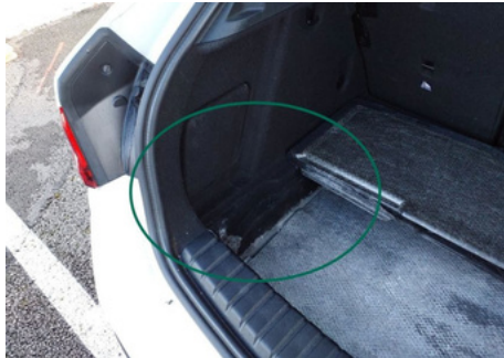
Garniture intérieure de coffre / Gauche / Déchiré
