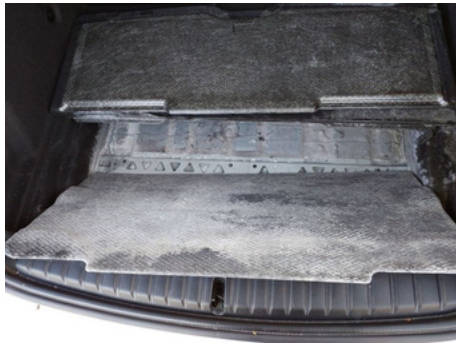
Plancher de coffre modulaire / - / Déchiré
