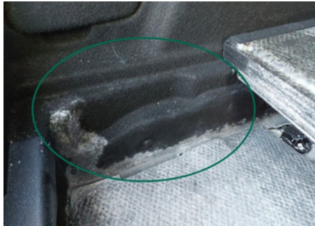
Garniture intérieure de coffre / Gauche / Déchiré
