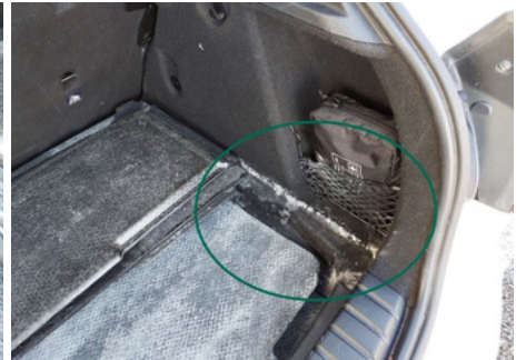
Garniture intérieure de coffre / Droit / Déchiré
