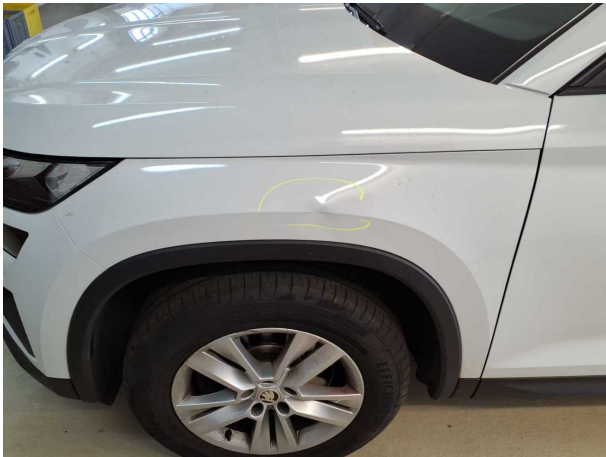
Beschädigung #7: Kotflügel links: Kotflügel links - Delle / Lackschaden - erneuern
