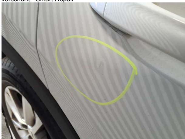
Beschädigung #5: Tür hinten rechts: Tür - Delle / Lackschaden - Smart Repair
