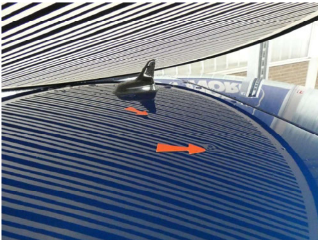
Dach - Dellen - entfernen
