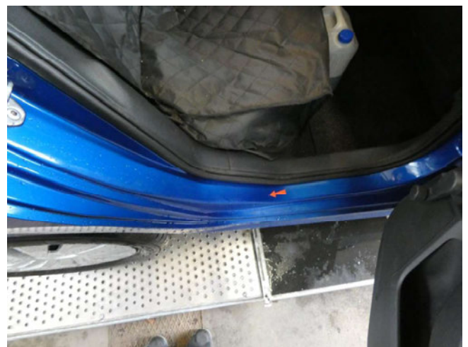
Tür hinten rechts - Einstieg-Kratzer-auslegen
