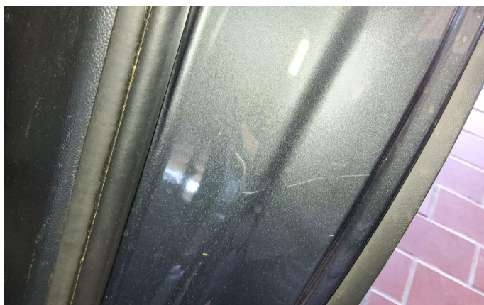
Bild 5: Außen, Tür hinten links - Einstieg Lackierung, zerkratzt, smart repair
