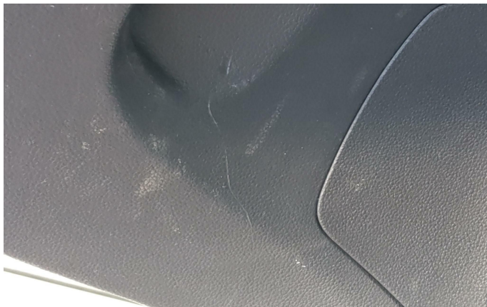
Bild 1: Innen, Verkleidung Heckklappe, zerkratzt, Gebrauchsspur
