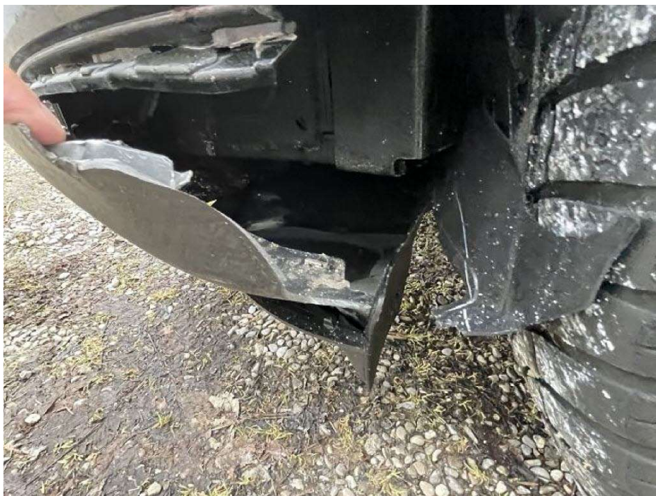
Bild 14 Spoiler vorne gebrochen
