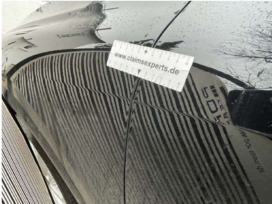
Bild 21 Türe vorne links verformt
