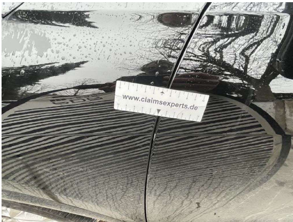
Bild 20 Türe vorne links verformt
