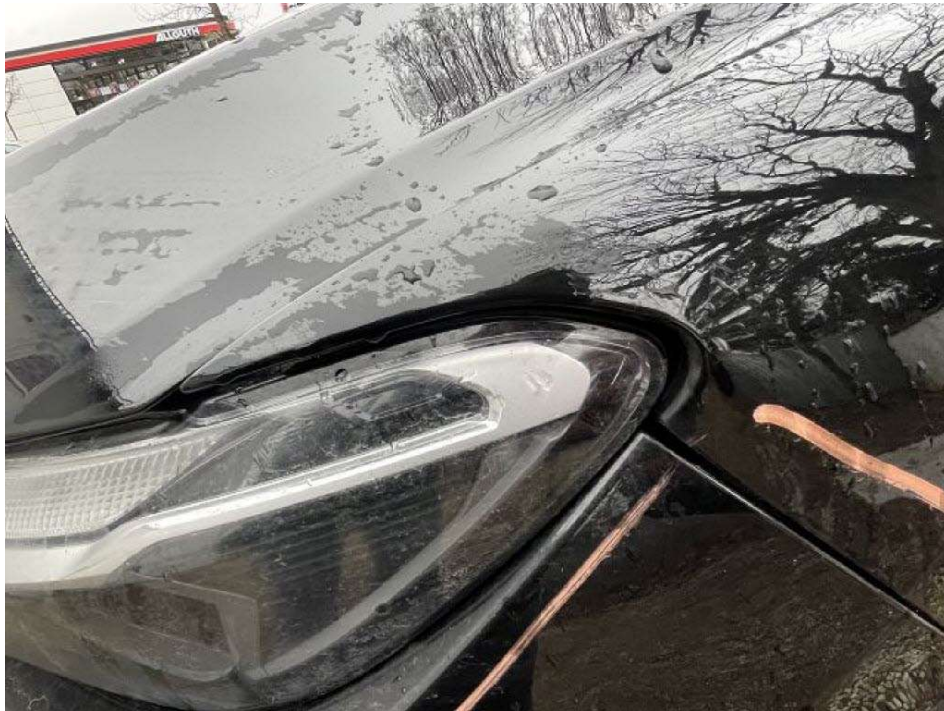
Bild 9 Scheinwerfer links verschrammt und verformt
