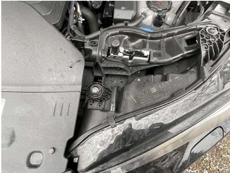
Bild 7 Scheinwerfer links verschrammt und verformt
