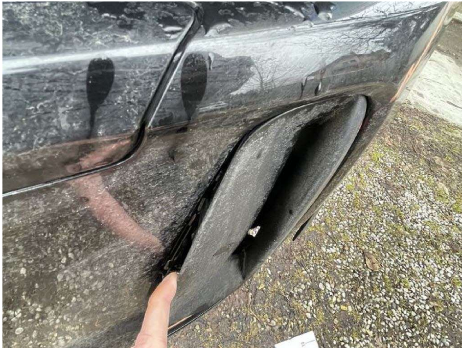
Bild 11 Abdeckung vorne links gebrochen
