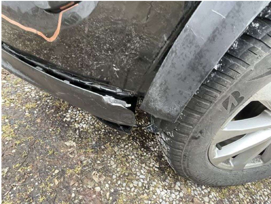
Bild 13 Spoiler vorne gebrochen
