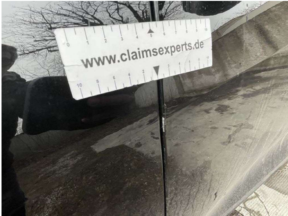
Bild 17 Türe vorne links verformt
