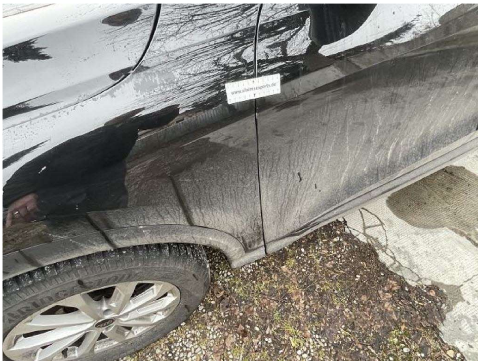
Bild 16 Türe vorne links verformt
