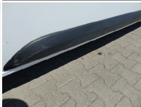
Türzürleiste / Rechts / Kratzer
