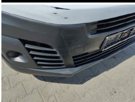
Stoßfänger unterhalb / Vorne / Delle
