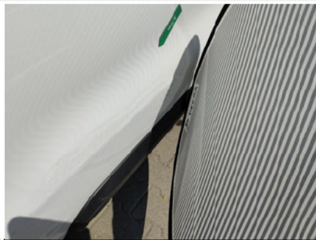
Tür / Rechts / Delle
