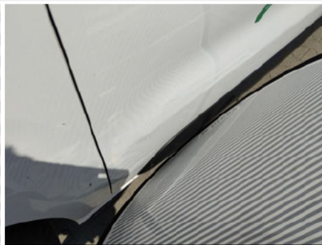
Tür / Rechts / Delle
