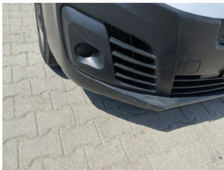
Stoßfänger unterhalb / Vorne / Delle
