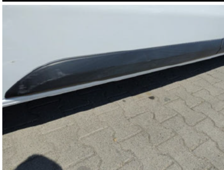
Türzürleiste / Rechts / Kratzer
