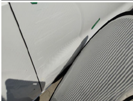
Tür / Rechts / Delle
