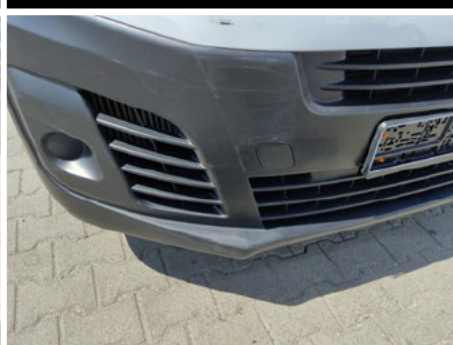
Stoßfänger unterhalb / Vorne / Delle
