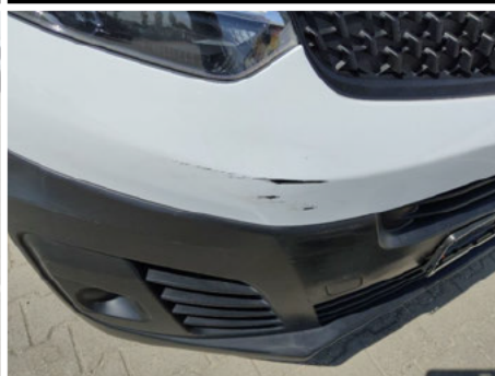
Stoßfänger oberhalb / Vorne / Kratzer
