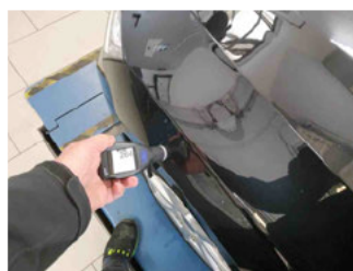
Lackstärke Kotflügel vorne links
