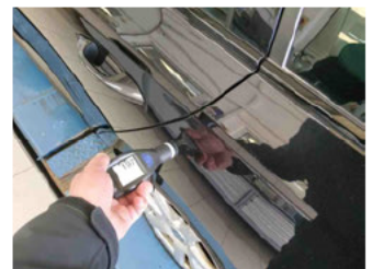
Lackstärke Seitenwand hinten links
