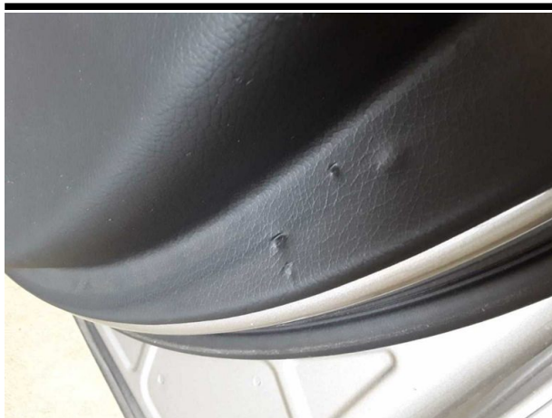
Beschädigung #7: Verkleidungen/Abdeckungen: Türverkleidung vorn rechts - beschädigt - erneuern
