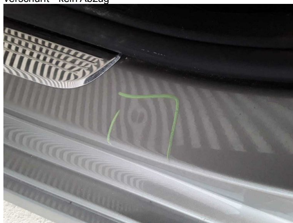
Beschädigung #3: Schweller links: Einstieg - Delle(n) - sanft instandsetzen
