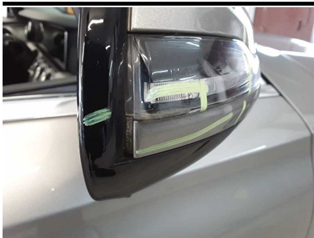
Beschädigung #4: Blinkleuchte: Spiegel rechts - verkratzt / verschürft - erneuern
