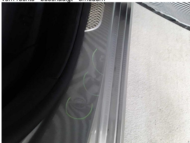
Beschädigung #8: Schweller rechts: Einstieg - Delle / Lackschaden - instandsetzen und lackieren
