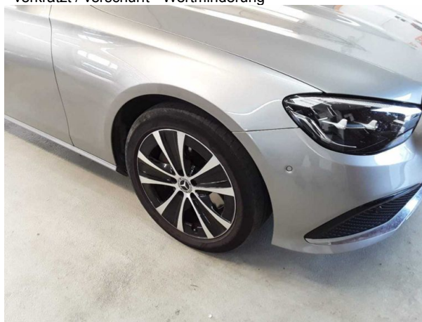
Beschädigung #6: Rad/Reifen: Reifen vorn - verschlissen - erneuern
