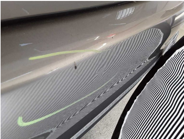
Beschädigung #9: Stossfänger hinten: Stossfänger hinten - Delle / Lackschaden - instandsetzen und lackieren
