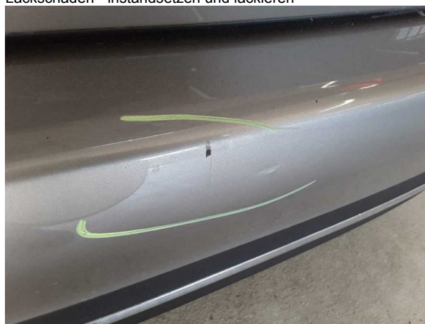
Beschädigung #9: Stossfänger hinten: Stossfänger hinten - Delle / Lackschaden - instandsetzen und lackieren
