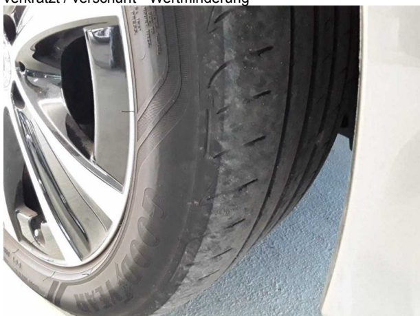
Beschädigung #6: Rad/Reifen: Reifen vorn - verschlissen - erneuern
