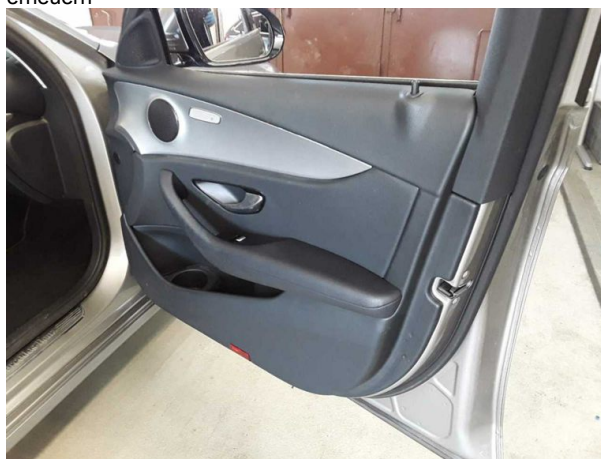
Beschädigung #7: Verkleidungen/Abdeckungen: Türverkleidung vorn rechts - beschädigt - erneuern
