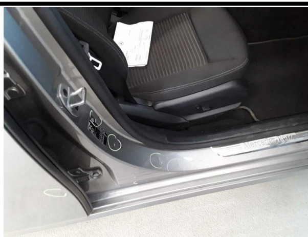
Beschädigung #8: Schweller rechts: Einstieg - Delle / Lackschaden - instandsetzen und lackieren
