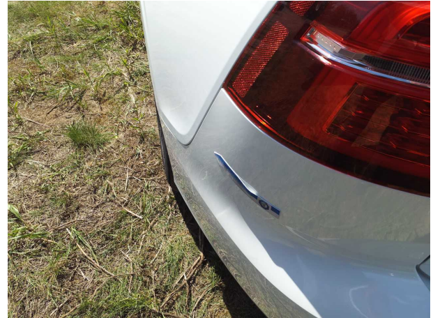
Beschädigung #1: Stossfänger hinten: Stossfänger hinten - Fehlstellung - befunden ggf. instandsetzen
