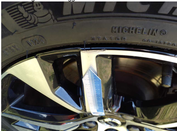
Beschädigung #2: Rad/Reifen: Leichtmetallfelge hinten rechts - Kratzer - Wertminderung
