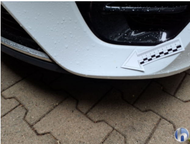
2. Stoßfänger Vorne Kratzer - Smart Repair
