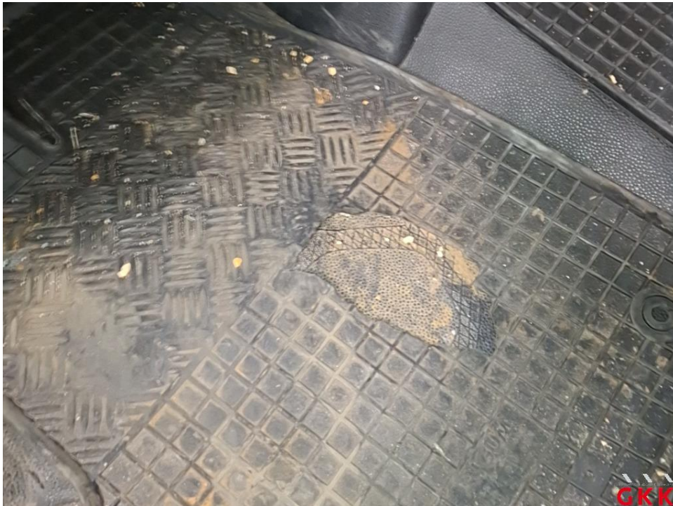
Bild 25 Fußmatte(n), vorne links, beschädigt, ersetzen
