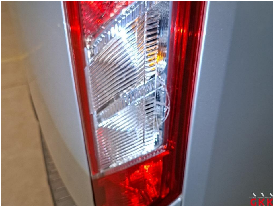
Bild 17 Rückleuchte rechts, außen, zerbrochen, ersetzen
