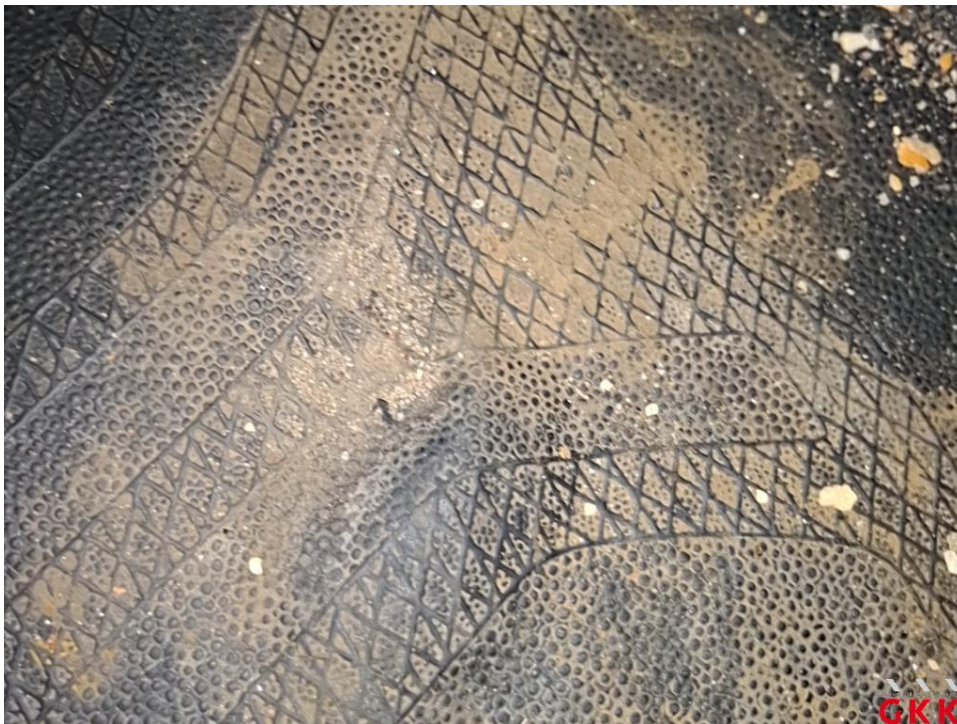
Bild 30 Fahrerhaus, Bodenbelag, beschädigt, Smartrepair
