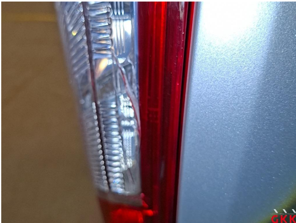
Bild 18 Rückleuchte rechts, außen, zerbrochen, ersetzen
