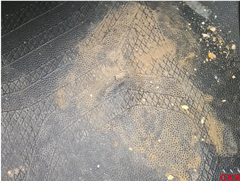
Bild 29 Fahrerhaus, Bodenbelag, beschädigt, Smartrepair
