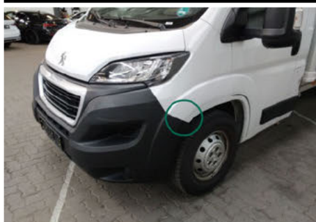
Stoßfängerhalter / Vorne Links / Gebrochen
