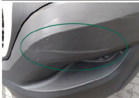
Stoßfänger / Vorne Links / Kratzer
