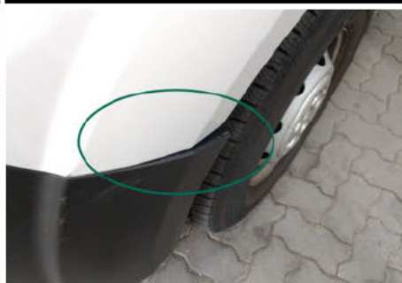
Stoßfängerhalter / Vorne Links / Gebrochen
