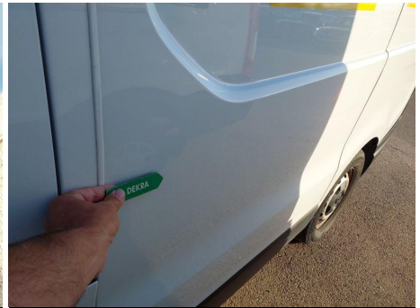
Panel lateral / Delantero Izquierdo / Abolladura
