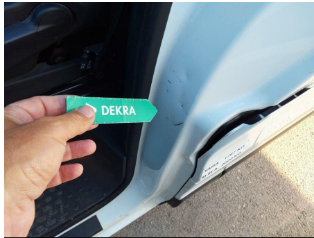
Travesaño de la puerta / Delantero Izquierdo / Abolladura
