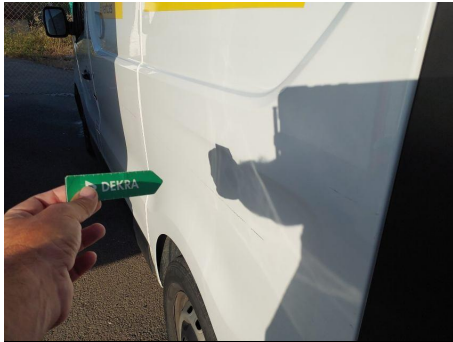
Panel lateral / Trasero Izquierdo / Abolladura
