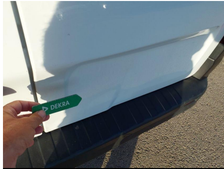
Portón trasero / puerta del maletero / Trasero Derecho / Abolladura
