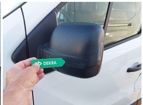
Carcasa del espejo de la puerta exterior / Izquierda / Roto
