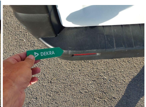
Paragolpes / Trasero / Abolladura
