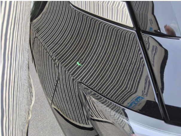
Beschädigung #4: Karosserie: Karosserie - Hagelschaden - instandsetzen
