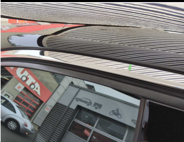
Beschädigung #4: Karosserie: Karosserie - Hagelschaden - instandsetzen
