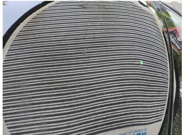
Beschädigung #4: Karosserie: Karosserie - Hagelschaden - instandsetzen
