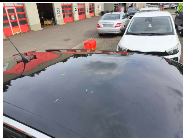
Beschädigung #4: Karosserie: Karosserie - Hagelschaden - instandsetzen
