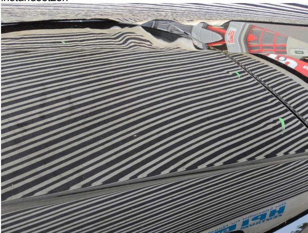
Beschädigung #4: Karosserie: Karosserie - Hagelschaden - instandsetzen
