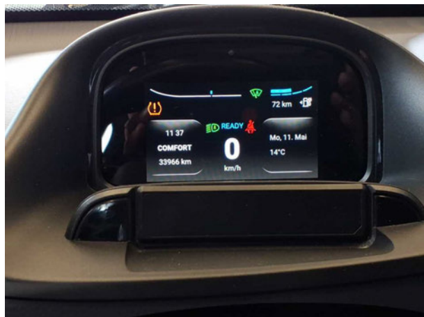
Beschädigung #1: Rad/Reifen: Drucksensor (Folgekosten möglich) - leuchtet - befunden ggf. instandsetzen
