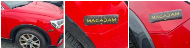
Wing trim FR, Scratch(es), Replace
