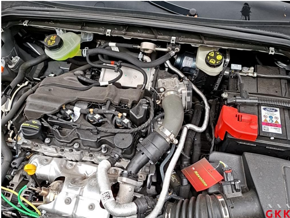
Bild 12. Motor, Ladeluftschlauch, beschädigt, ersetzen
