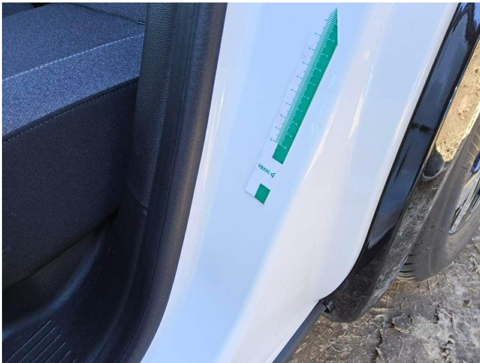
Bild 10 : Tür hinten links Einstieg, eingedellt, smart repair
