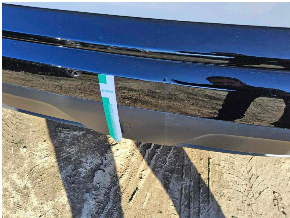
Bild 12 : Stoßfänger hinten, Mittelteil und Unterteil deformiert
