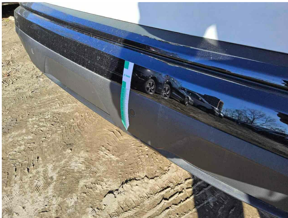
Bild 11 : Stoßfänger hinten, Mittelteil und Unterteil deformiert
