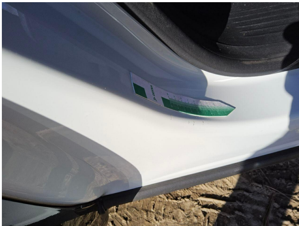
Bild 13 : Tür hinten rechts Einstieg Lackierung, zerkratzt, smart repair
