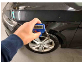
Lackstärke Kotflügel vorne links
