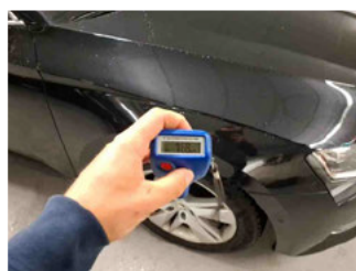
Lackstärke Kotflügel vorne rechts
