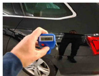
Lackstärke Seitenwand hinten links
