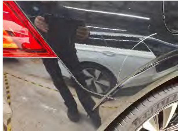
Beschädigung #8: Seitenwand rechts: Seitenwand - Kratzer - Smart Repair
