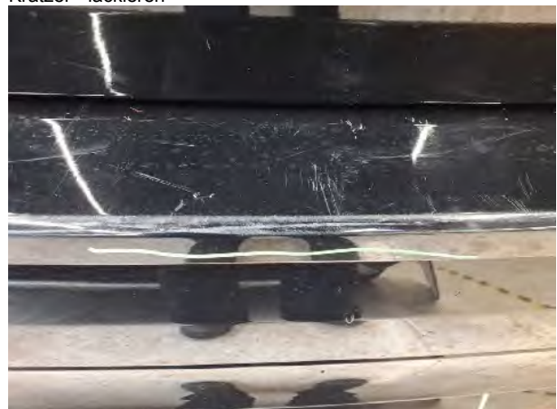
Beschädigung #15: Stossfänger hinten: Stossfänger hinten - Kratzer - lackieren
