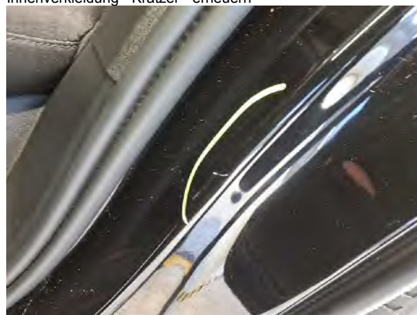
Beschädigung #2: Seitenwand links: Einstieg - Kratzer - Smart Repair
