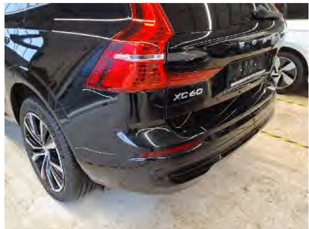
Beschädigung #15: Stossfänger hinten: Stossfänger hinten - Kratzer - lackieren
