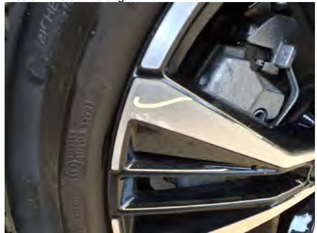
Beschädigung #5: Rad/Reifen: Leichtmetallfelge vorn links - Kratzer - Wertminderung
