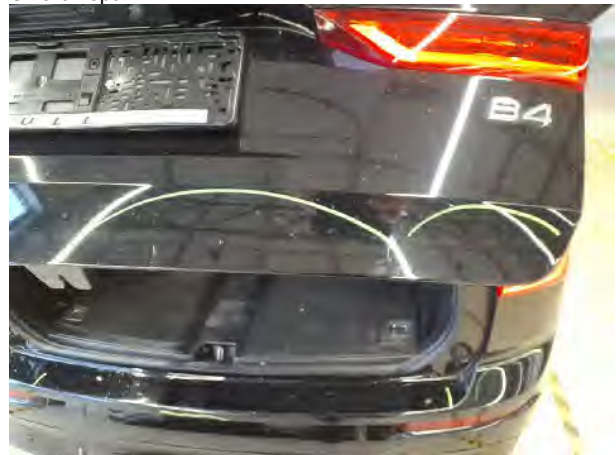
Beschädigung #9: Heckklappe/-tür: Heckklappe - Kratzer - Smart Repair
