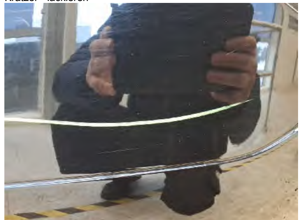
Beschädigung #15: Stossfänger hinten: Stossfänger hinten - Kratzer - lackieren
