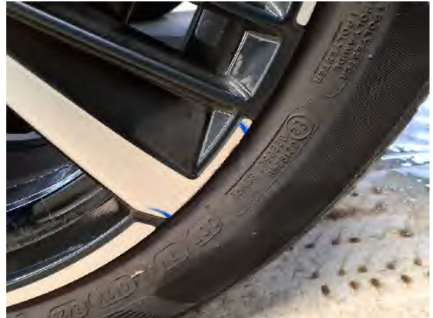
Beschädigung #6: Rad/Reifen: Leichtmetallfelge vorn rechts - Kratzer - Wertminderung
