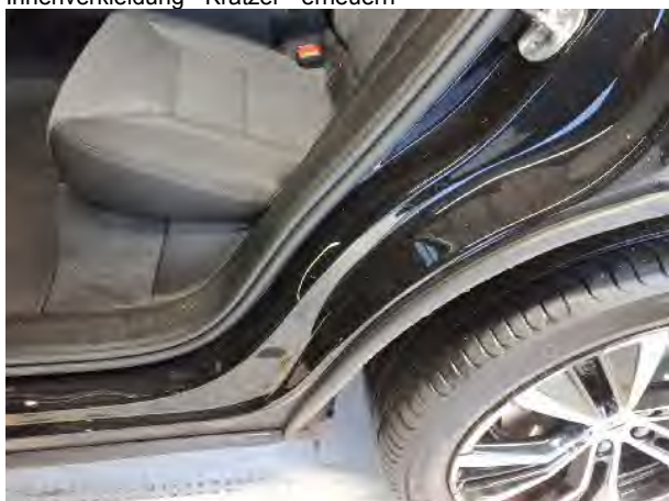
Beschädigung #2: Seitenwand links: Einstieg - Kratzer - Smart Repair
