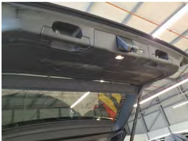
Beschädigung #1: Verkleidungen/Abdeckungen: Heckdeckel, Innenverkleidung - Kratzer - erneuern
