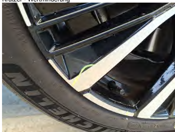
Beschädigung #4: Rad/Reifen: Leichtmetallfelge hinten links - Kratzer - Wertminderung
