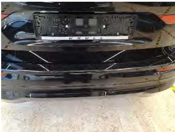
Beschädigung #15: Stossfänger hinten: Stossfänger hinten - Kratzer - lackieren
