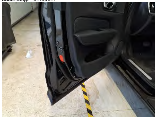
Beschädigung #13: Verkleidungen/Abdeckungen: Türverkleidung vorn links - verformt - erneuern
