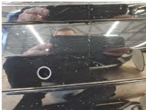
Beschädigung #15: Stossfänger hinten: Stossfänger hinten - Kratzer - lackieren
