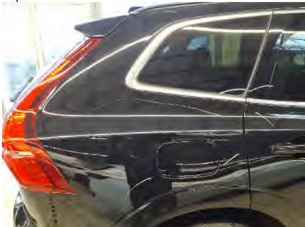
Beschädigung #8: Seitenwand rechts: Seitenwand - Kratzer - Smart Repair
