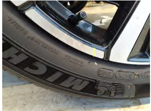
Beschädigung #4: Rad/Reifen: Leichtmetallfelge hinten links - Kratzer - Wertminderung
