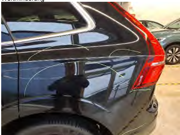
Beschädigung #7: Seitenwand links: Seitenwand - Kratzer - Smart Repair
