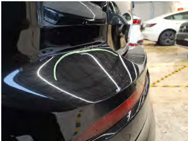
Beschädigung #15: Stossfänger hinten: Stossfänger hinten - Kratzer - lackieren
