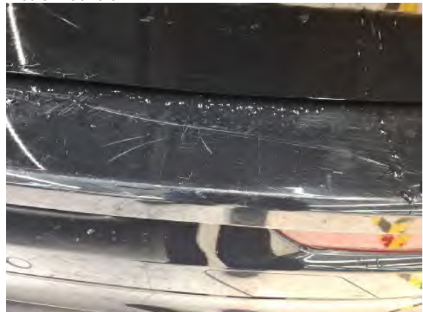
Beschädigung #15: Stossfänger hinten: Stossfänger hinten - Kratzer - lackieren
