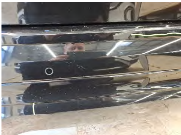
Beschädigung #15: Stossfänger hinten: Stossfänger hinten - Kratzer - lackieren
