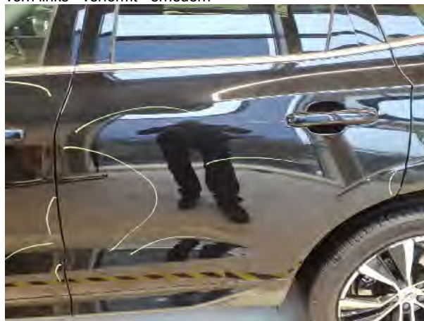
Beschädigung #14: Tür hinten links: Tür - Kratzer - lackieren
