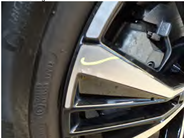
Beschädigung #5: Rad/Reifen: Leichtmetallfelge vorn links - Kratzer - Wertminderung
