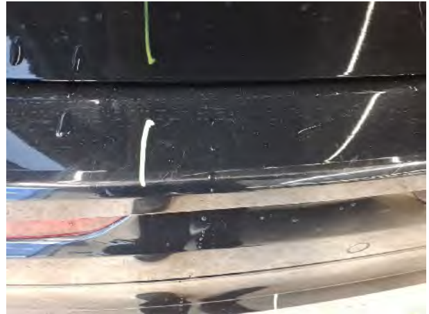
Beschädigung #15: Stossfänger hinten: Stossfänger hinten - Kratzer - lackieren
