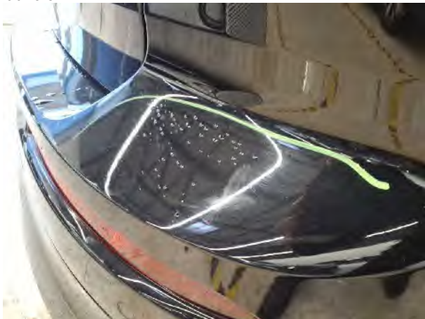
Beschädigung #15: Stossfänger hinten: Stossfänger hinten - Kratzer - lackieren
