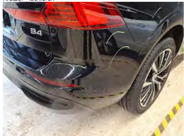
Beschädigung #15: Stossfänger hinten: Stossfänger hinten - Kratzer - lackieren
