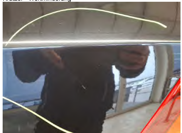
Beschädigung #7: Seitenwand links: Seitenwand - Kratzer - Smart Repair
