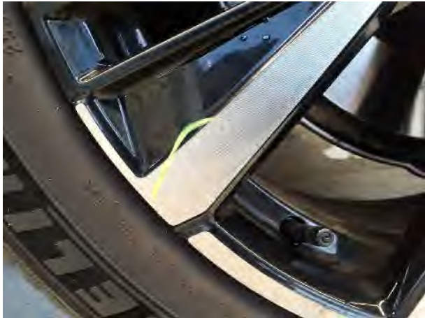
Beschädigung #4: Rad/Reifen: Leichtmetallfelge hinten links - Kratzer - Wertminderung
