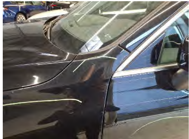
Beschädigung #10: Kotflügel links: Kotflügel links (Anätzung) - Kratzer - Smart Repair
