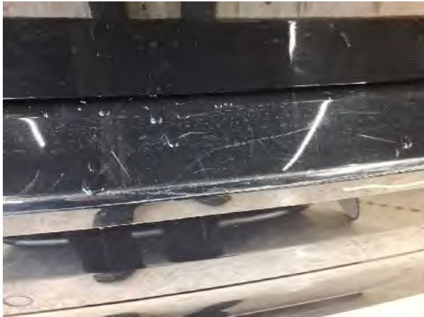
Beschädigung #15: Stossfänger hinten: Stossfänger hinten - Kratzer - lackieren
