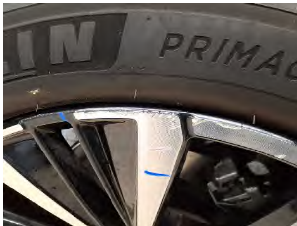
Beschädigung #12: Rad/Reifen: Leichtmetallfelge hinten rechts - beschädigt - erneuern
