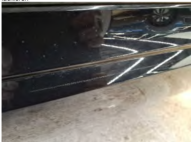
Beschädigung #15: Stossfänger hinten: Stossfänger hinten - Kratzer - lackieren
