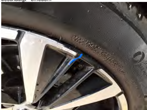
Beschädigung #12: Rad/Reifen: Leichtmetallfelge hinten rechts - beschädigt - erneuern
