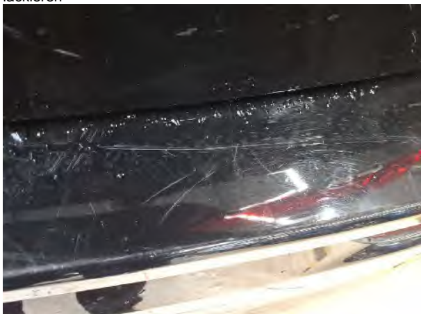
Beschädigung #15: Stossfänger hinten: Stossfänger hinten - Kratzer - lackieren
