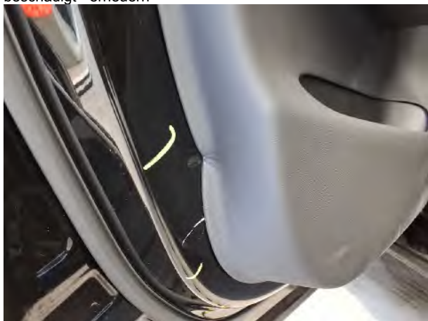
Beschädigung #13: Verkleidungen/Abdeckungen: Türverkleidung vorn links - verformt - erneuern
