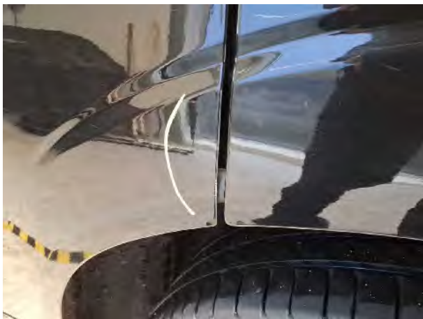
Beschädigung #14: Tür hinten links: Tür - Kratzer - lackieren
