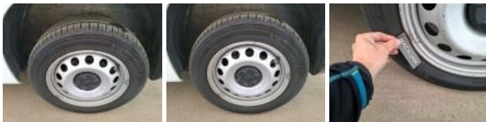
Jante tôle ARD, Déformé / Forcé, E - Remplacer
