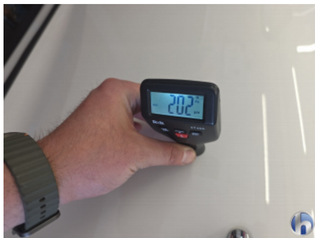
1. Tür Vorne - Links Nachlackiert - Ohne Reparatur
