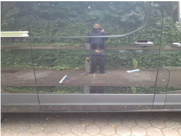
Beschädigung #5: Schiebetür rechts: Schiebetür - verkratzt / verschürft - lackieren
