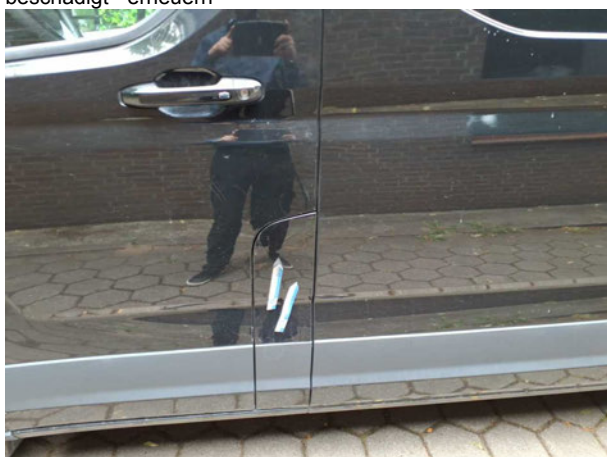
Beschädigung #2: Kraftstoffanlage: Tankklappe - verformt - erneuern
