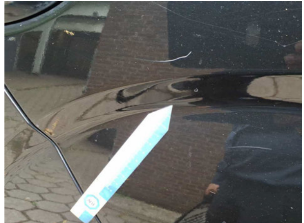
Beschädigung #4: Kotflügel links: Kotflügel links - Delle / Lackschaden - instandsetzen und lackieren
