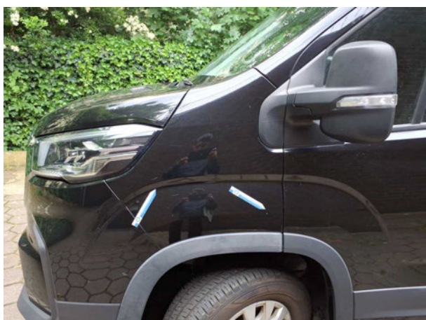
Beschädigung #4: Kotflügel links: Kotflügel links - Delle / Lackschad... - instandsetzen und lackieren
