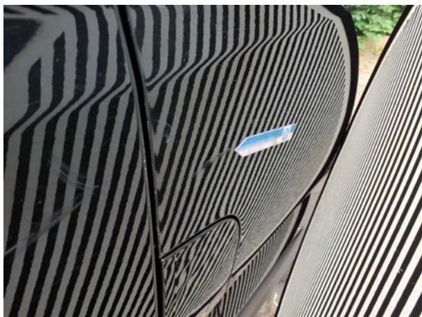
Beschädigung #6: Tür vorn rechts: Tür - Delle / Lackschaden - instandsetzen und lackieren
