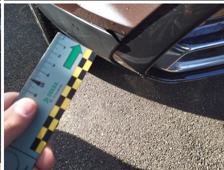
Parte inferiore paraurti / Posteriore / Rotto
