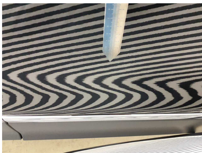
Damage 13: Door - front right side: Door (Kratzer im spachtel) - Unprofessionally repaired - Paint
