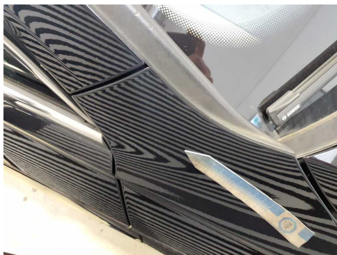
Damage 14: Mudguard - right side: Mudguard - right side (Wellig und einschüsse) - Unprofessionally repaired - Paint
