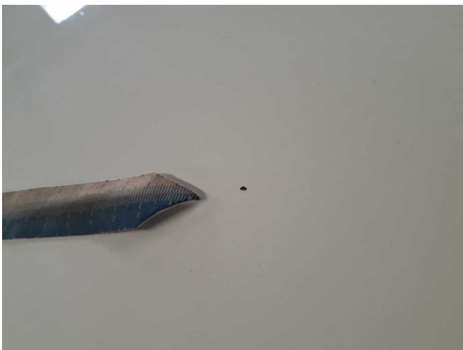
Damage 5: Bonnet: Bonnet (Sandstrahleffekt) - Stone chips - Paint
