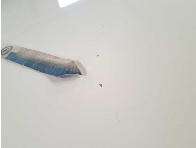
Damage 5: Bonnet: Bonnet (Sandstrahleffekt) - Stone chips - Paint
