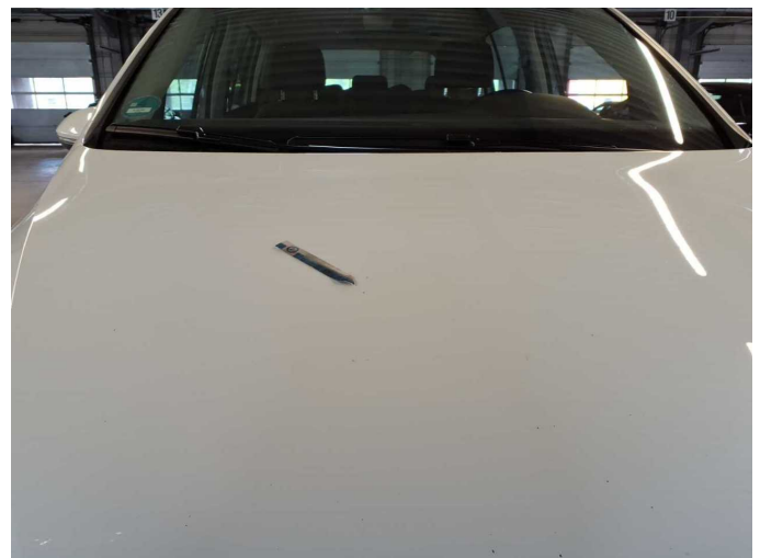
Damage 5: Bonnet: Bonnet (Sandstrahleffekt) - Stone chips - Paint
