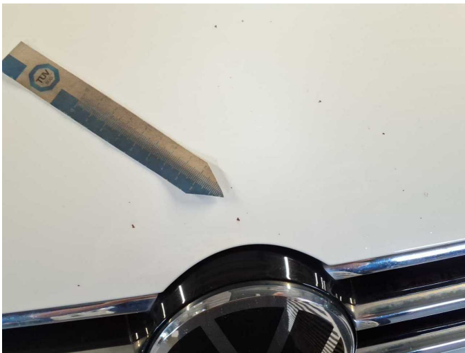
Damage 5: Bonnet: Bonnet (Sandstrahleffekt) - Stone chips - Paint
