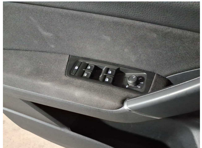
Damage 2: Door - front left side: Window regulator (+ rechts, Schalter ausgeleiert, Fenster fahren nicht aut.) - Sub-function - Perform diagnosis
