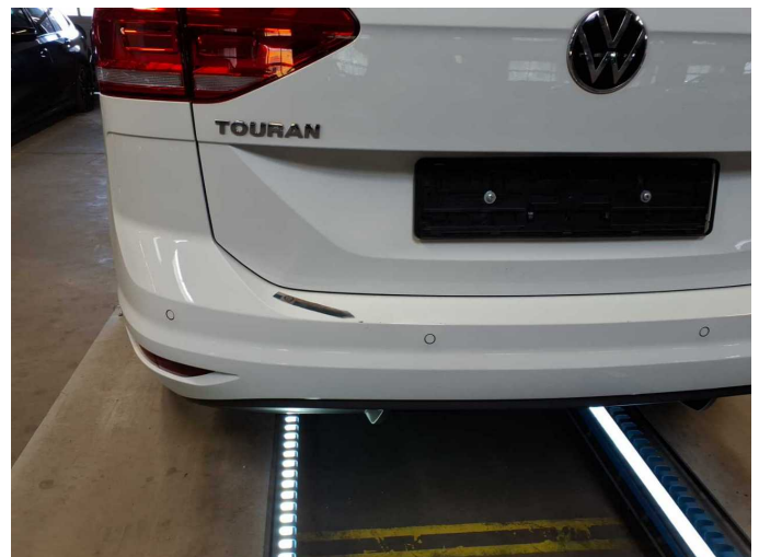
Damage 3: Rear bumper: Rear bumper (Verladebereich) - Scratch(es) - Smart repair
