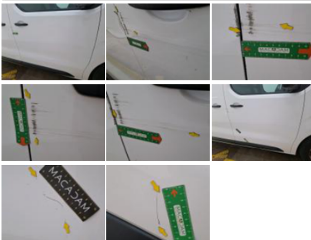
Moulure porte ARD, Déformé / Forcé, E - Remplacer
