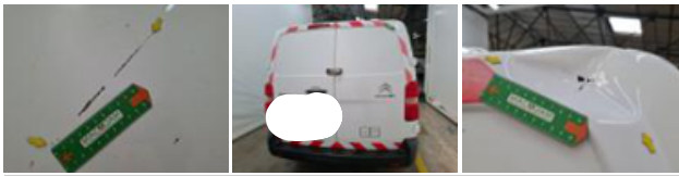
Feu ARD, Cassé, E - Remplacer
