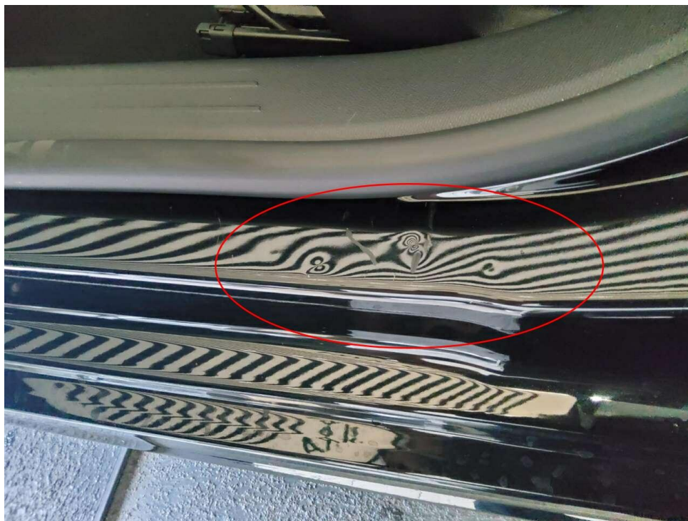
Bild 16 : Tür vorne links Einstieg, deformiert, instandsetzen und lackieren mit Lackaufbau
