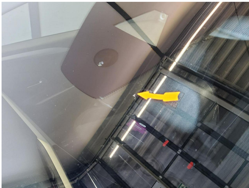
Bild 14 : Frontscheibe, Steinschlag, Gebrauchsspur
