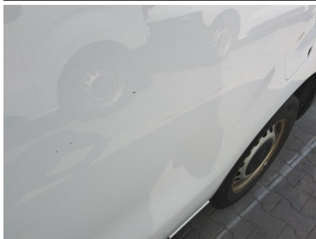
Seitenwand / Hinten Links / Delle
