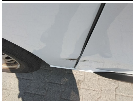
Seitenwand / Hinten Rechts / Delle
