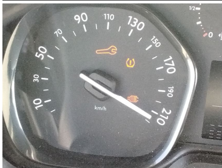
Warnleuchte Inspektion / Fehlt
