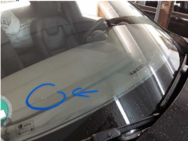
Beschädigung #3: Verglasung: Frontscheibe (Rissbildung) - erneuern
