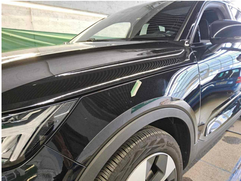
Bild 22 : Kotflügel vorne links Lackierung, Steinschlag, Gebrauchsspur
