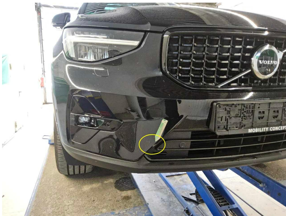
Bild 24 : Stoßfänger vorne Lackierung, verschrammt, smart repair
