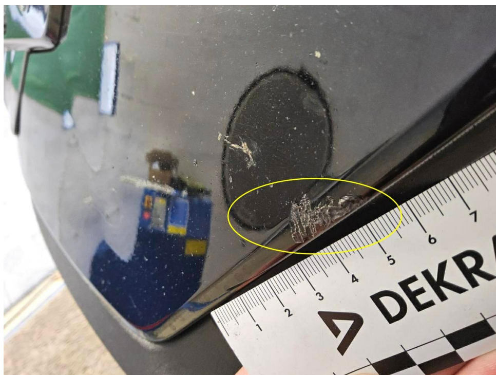
Bild 25 : Stoßfänger vorne Lackierung, verschrammt, smart repair
