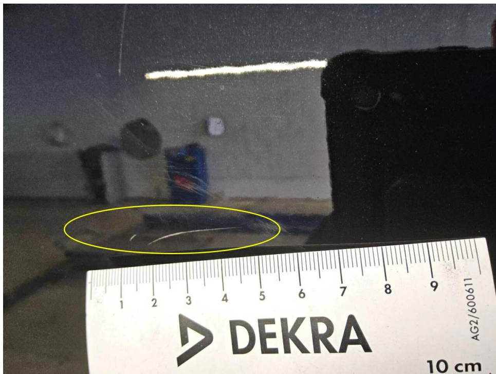
Bild 21 : Tür hinten links Lackierung, zerkratzt, lackieren mit Lackaufbau
