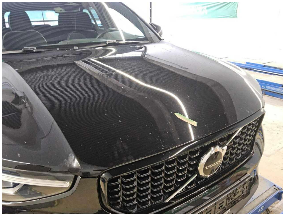
Bild 16 : Motorhaube Lackierung, Steinschlag, Gebrauchsspur
