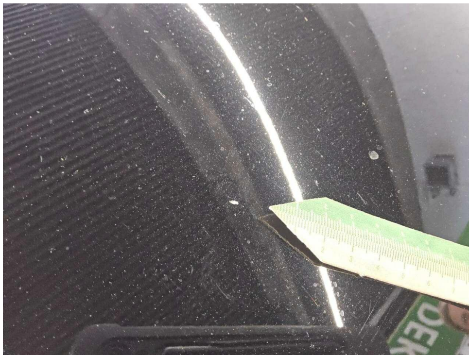
Bild 17 : Motorhaube Lackierung, Steinschlag, Gebrauchsspur
