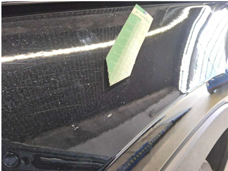
Bild 23 : Kotflügel vorne links Lackierung, Steinschlag, Gebrauchsspur
