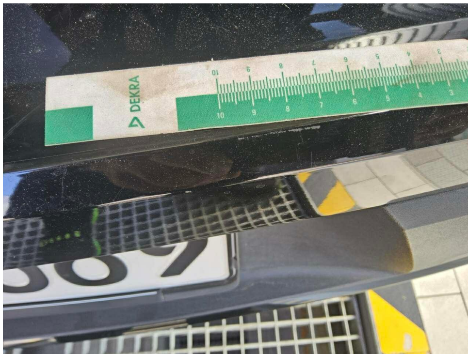
Bild 16 : Stoßfänger hinten Lackierung, verschrammt, Gebrauchsspur
