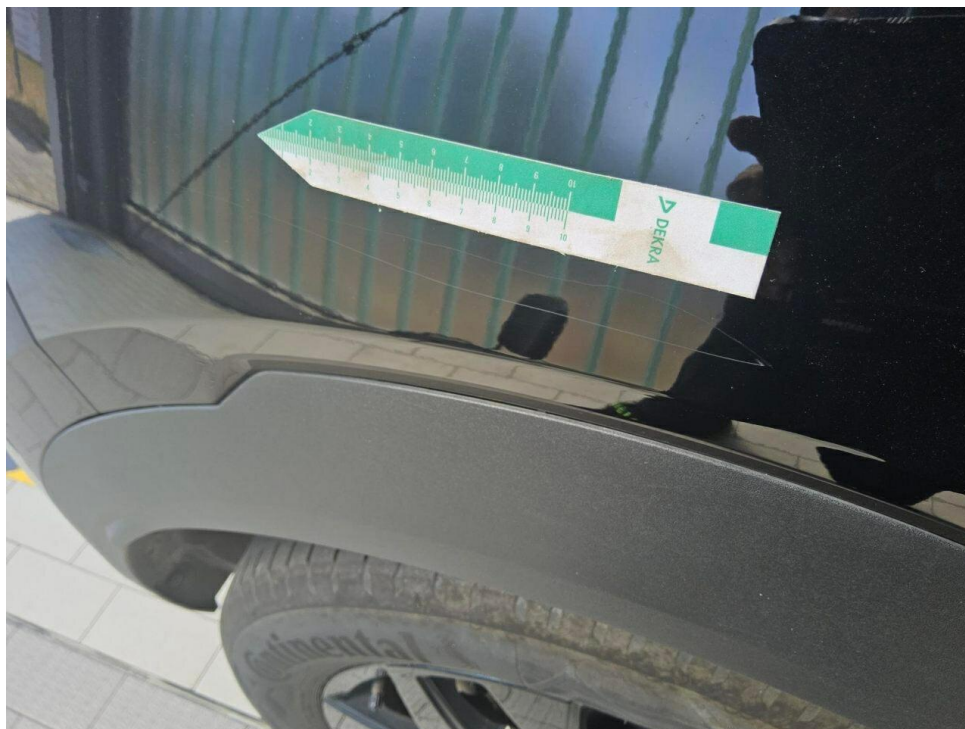
Bild 15 : Seitenteil hinten rechts Lackierung, zerkratzt, Gebrauchsspur
