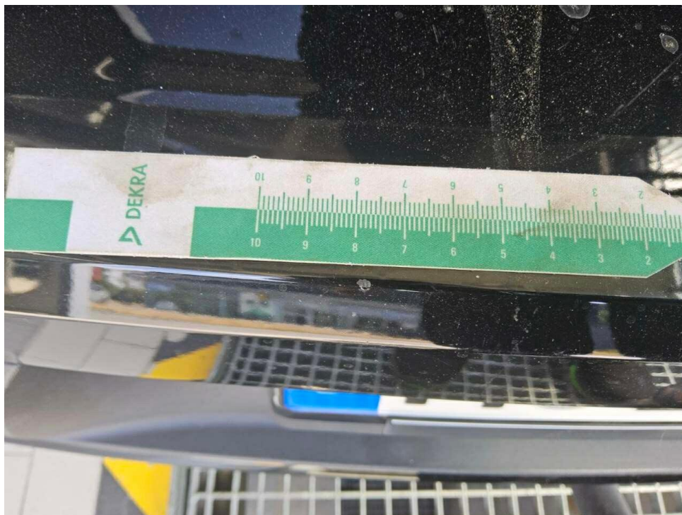
Bild 17 : Stoßfänger hinten Lackierung, verschrammt, Gebrauchsspur
