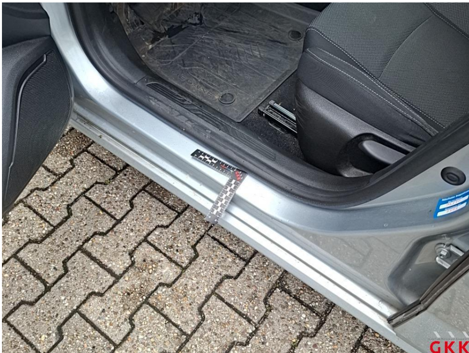
Bild 44. Tür vorne links, Einstieg, verkratzt, Smartrepair
