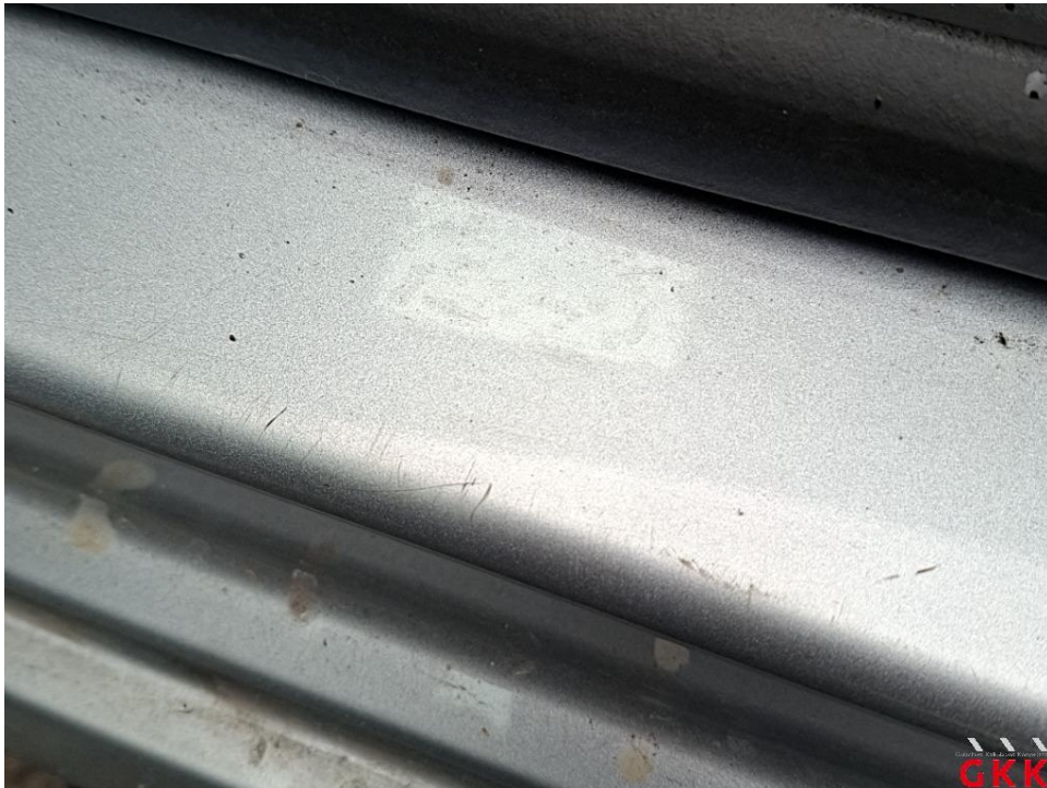
Bild 46. Tür vorne links, Einstieg, verkratzt, Smartrepair
