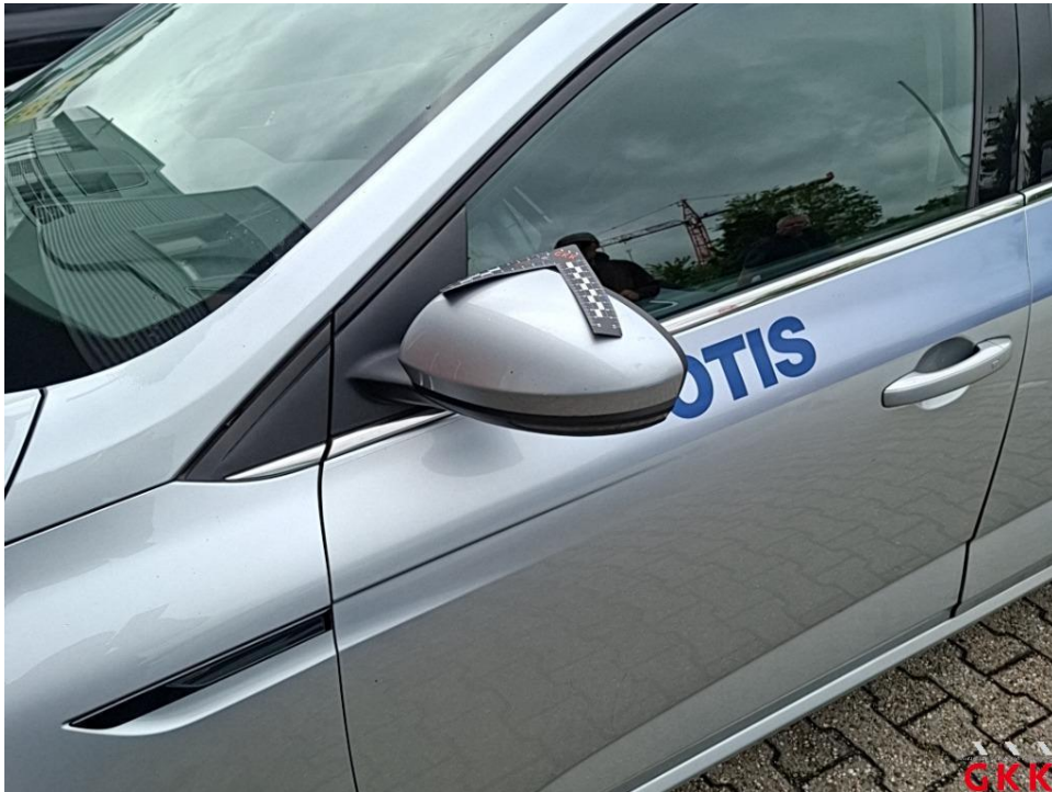
Bild 47. Spiegelgehäuse links, Kappe -lackiert-, verkratzt, lackieren
