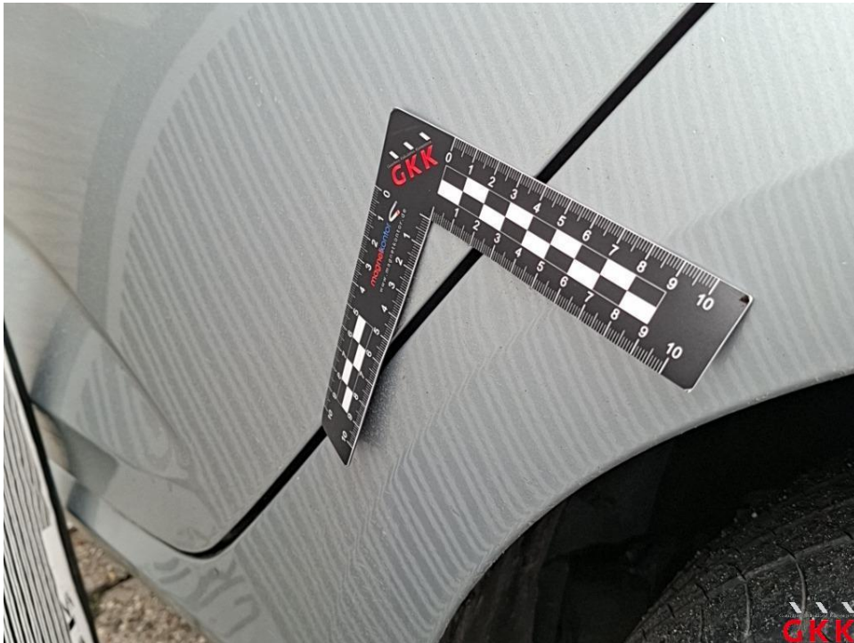
Bild 39. Seitenwand links, bis 3 Dellen / Bauteil, kalt drücken
