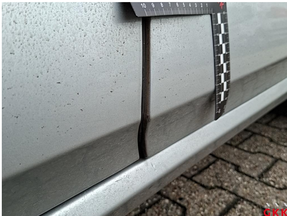
Bild 42. Tür hinten links, Spaltmaß fehlerhaft, nachstellen
