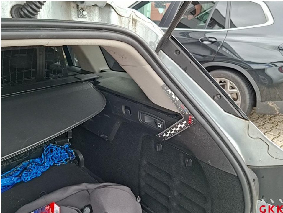
Bild 33. D- Säule rechts, Innenverkleidung, verkratzt, ersetzen
