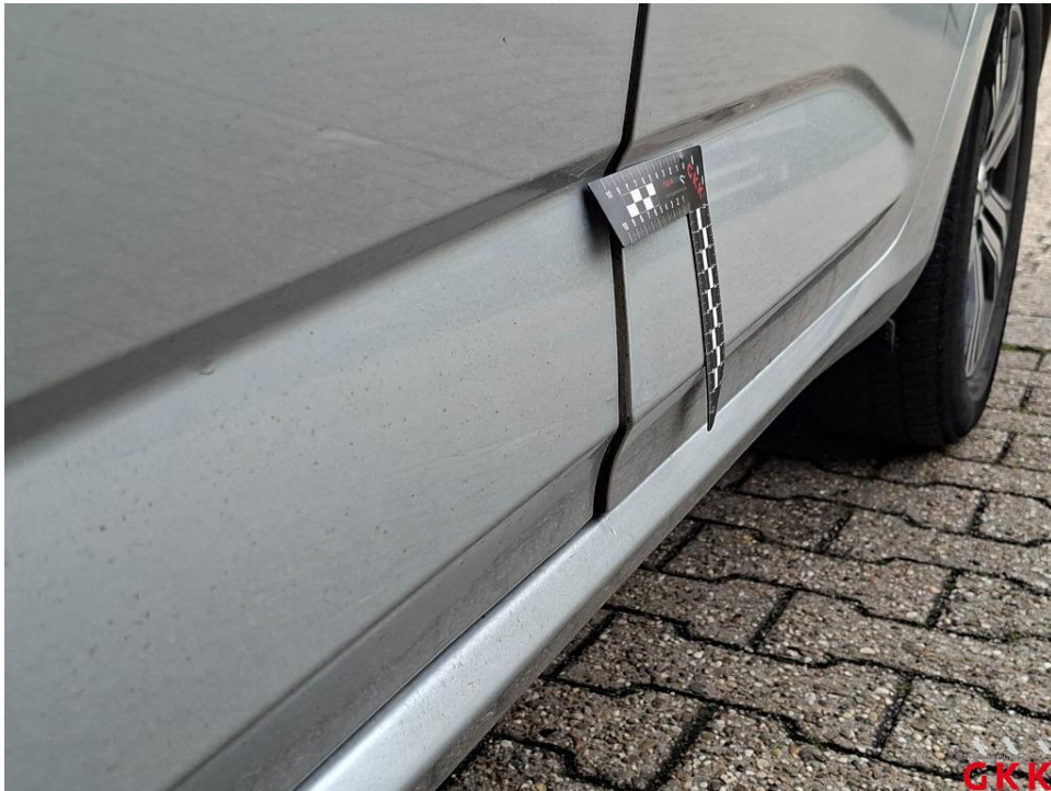
Bild 43. Tür hinten links, Spaltmaß fehlerhaft, nachstellen
