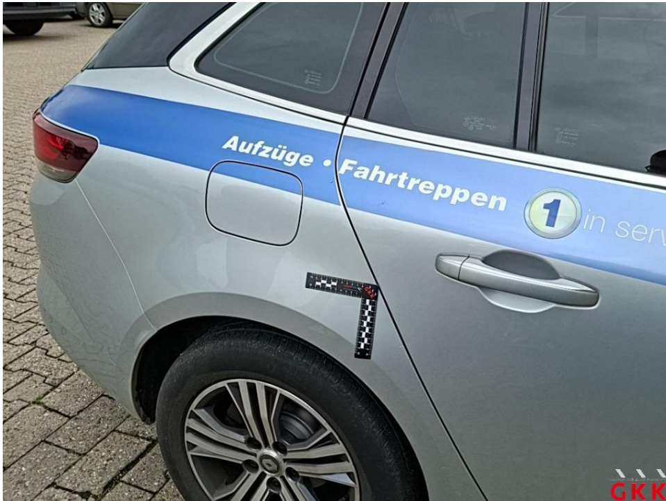
Bild 27. Seitenwand rechts, bis 3 Dellen / Bauteil, kalt drücken
