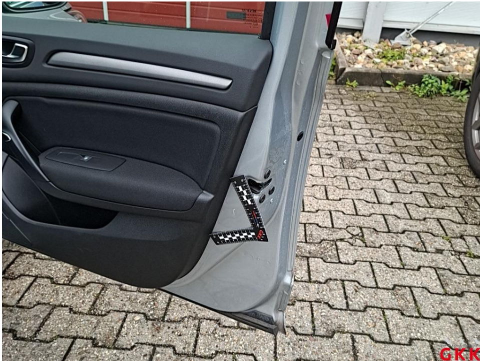
Bild 21. Tür vorne rechts, innen, beschädigt, Smartrepair
