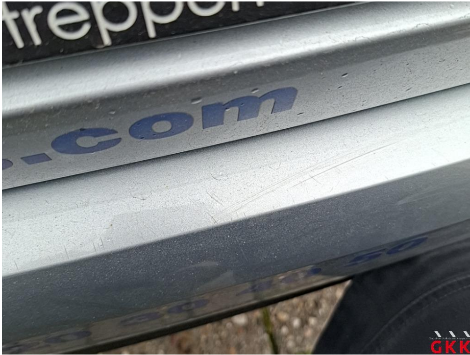
Bild 37. Stoßfänger hinten, Verkleidung -lackiert-, verkratzt, Smartrepair
