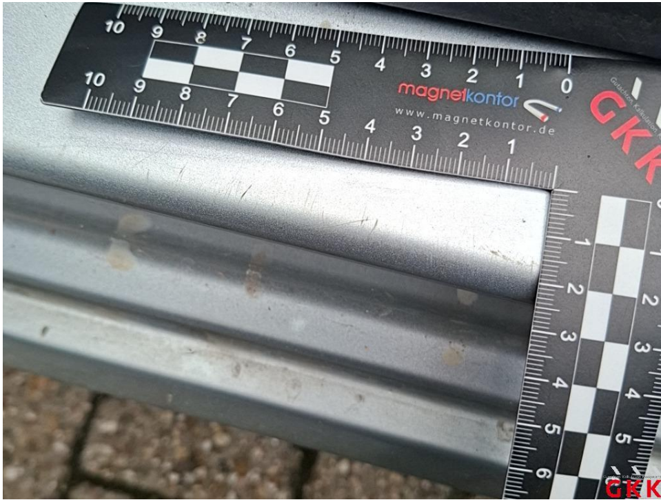
Bild 45. Tür vorne links, Einstieg, verkratzt, Smartrepair
