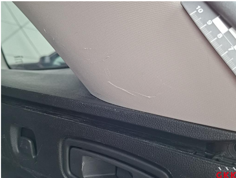
Bild 34. D- Säule rechts, Innenverkleidung, verkratzt, ersetzen
