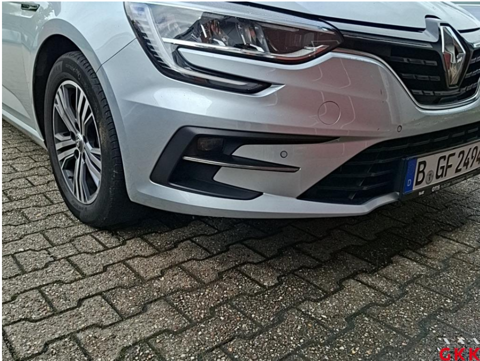
Bild 18. Stoßfänger vorne, Verkleidung unterhalb -lackiert-, verkratzt, Smartrepair
