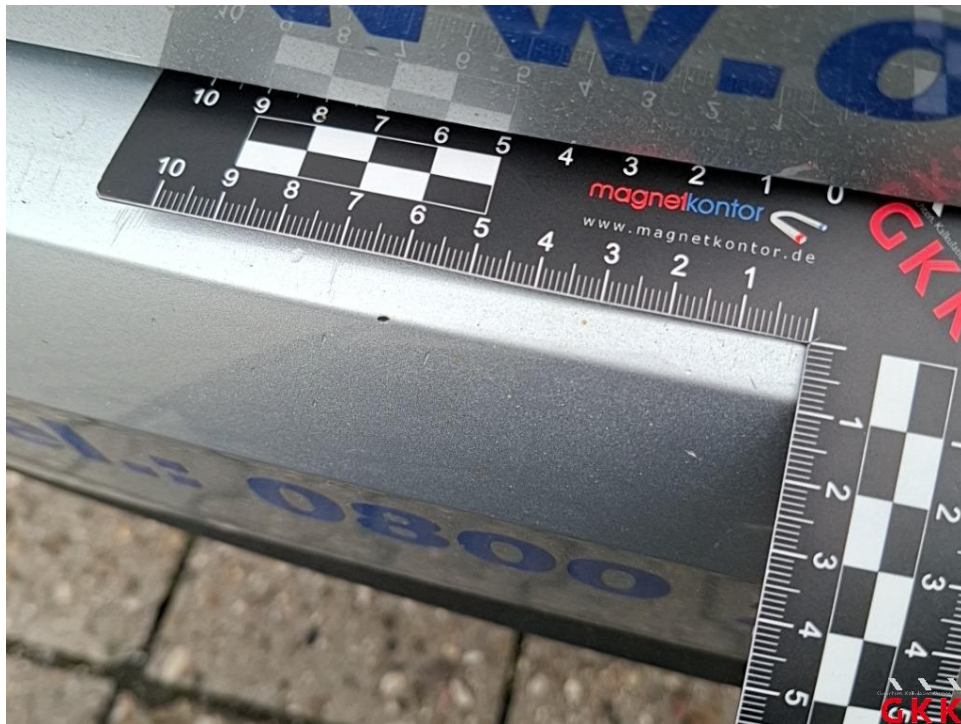
Bild 36. Stoßfänger hinten, Verkleidung -lackiert-, verkratzt, Smartrepair
