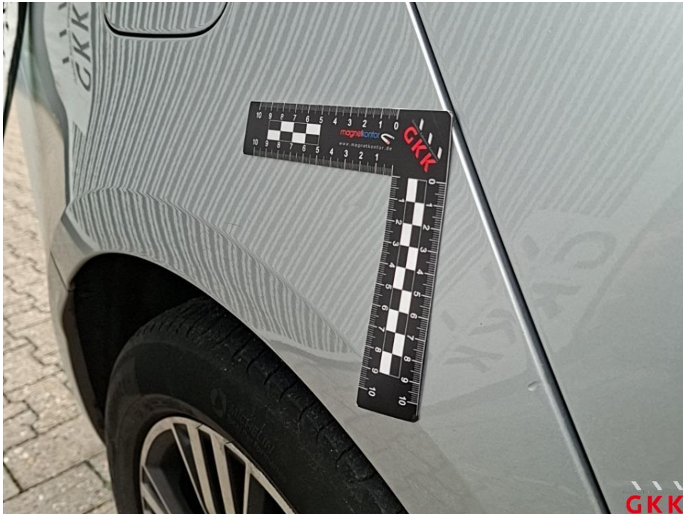
Bild 29. Seitenwand rechts, bis 3 Dellen / Bauteil, kalt drücken
