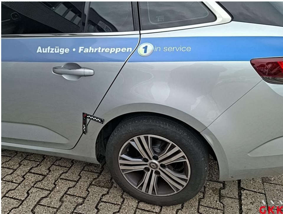
Bild 38. Seitenwand links, bis 3 Dellen / Bauteil, kalt drücken
