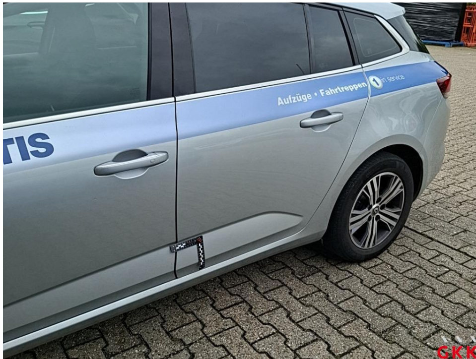
Bild 41. Tür hinten links, Spaltmaß fehlerhaft, nachstellen
