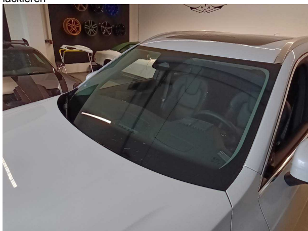
Beschädigung #2: Verglasung: Frontscheibe mit Spurhalteassistent - verkratzt / verschürft - erneuern
