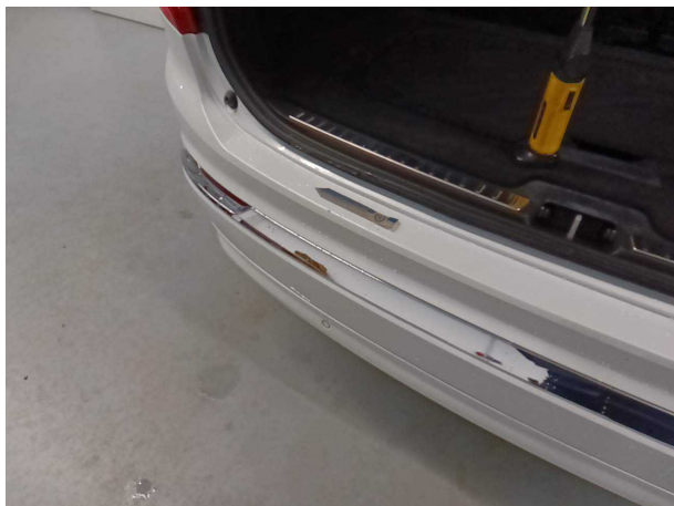
Beschädigung #1: Stossfänger hinten: Stossfänger hinten - Kratzer - lackieren
