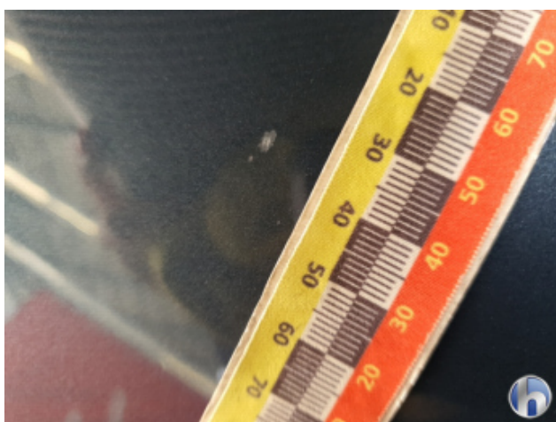
1. Motorhaube Lackabplatzer - Auslegen / Polieren
