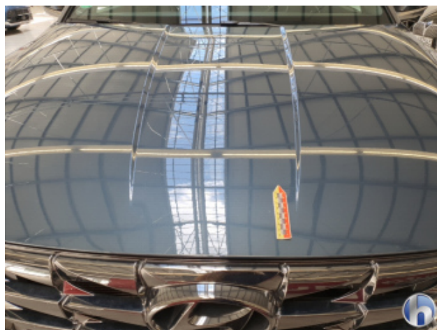
1. Motorhaube Lackabplatzer - Auslegen / Polieren
