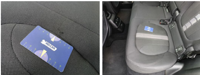
Zetels - Bekleding zit LA - Scheur - Vervangen
