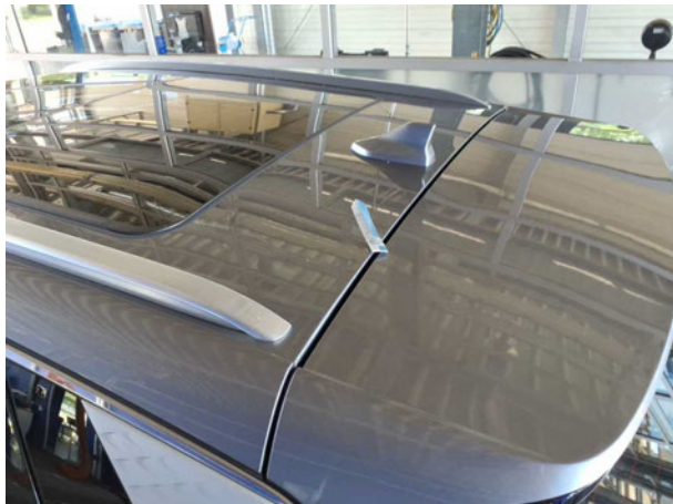
Beschädigung #1: Fahrzeugdach: Dach - Delle(n) - sanft instandsetzen
