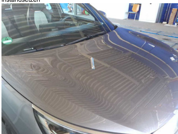
Beschädigung #2: Motorhaube: Motorhaube - Delle(n) - sanft instandsetzen
